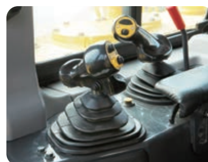
Levier de contrôle de la lame avec contrôle automatique de l'angle d'attaque et nouveau levier de contrôle du ripper avec relevage automatique du ripper
