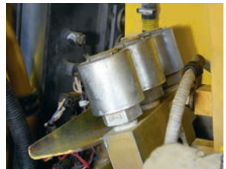
Entlüfterdosen erleichtern die Überprüfung und Reinigung (optional)
