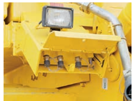
Leicht zugängliche Ablassventile mit Gewindestutzen (optional)
