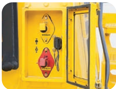
Isolationskasten für Batterie und Startermotor (in optional verfügbarer Bergbauspezifikation enthalten) mit Anschluss für Starthilfekabel
