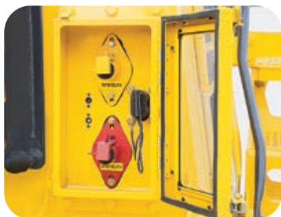
Caisson batterie et isolateur de démarreur (optionnel pour les modèles d'exploitation minière) avec prise pour démarrage par câbles volants
