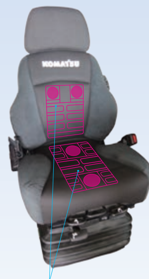
Zone chauffée et ventilée
