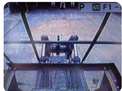
Sistema di telecamera posteriore completamente integrata
