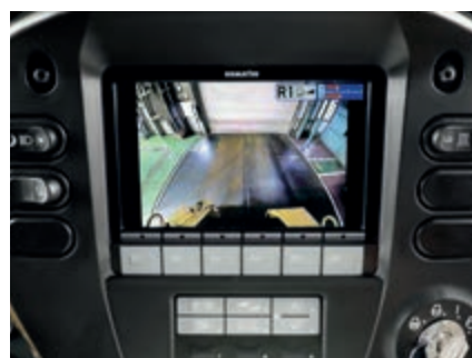
Système de caméra vue arrière complètement intégré
