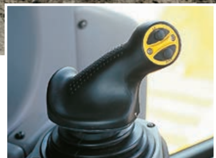
Système ergonomique PCCS (Palm Command Control System)
