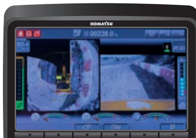
KomVision offre plusieurs vues grâce au réseau de caméras, tout en maintenant affichée en permanence une vue aérienne, depuis le dessus de la machine
