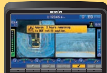
Niveau du liquide AdBlue® et assistance au remplissage
