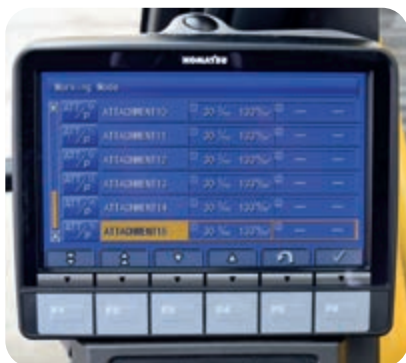
Komatsu Integrated Attachment Control (KIAC) con fino a 15 valori preimpostati per portata e pressione olio
