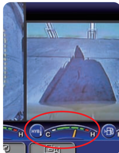
Indicatore della temperatura del sistema ibrido
