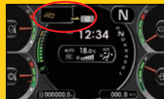
Avertissement de maintenance
