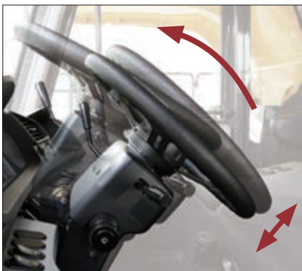
Disposizione del volante nella posizione più comoda
