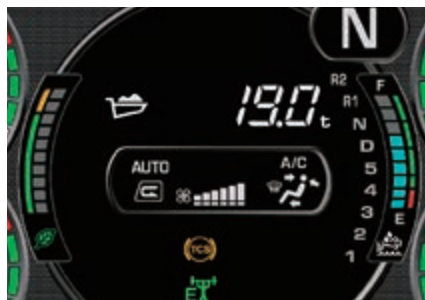
Die Zuladung ist auf der Anzeige der Nutzlastwaage ablesbar
