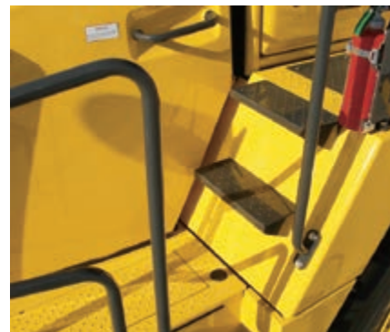
Handlauf für sicheren Zugang zum Fahrerhaus in sicherer Entfernung zum Gelenkbereich
