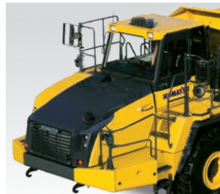
Die integrierten ROPS/FOPS-Strukturen entsprechen den Normen ISO 3471 und SAE J1040-1988c.
