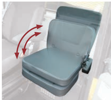
Ist der vollwertige Beifahrersitz zusammengeklappt, kann der Fahrer bequem ins Fahrerhaus einsteigen und hat freien Zugriff auf den Luftfilter der Klimaanlage und das Staufach.
