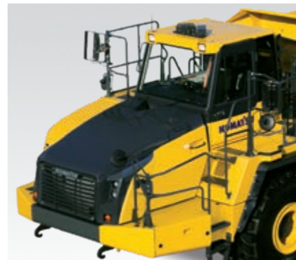
ROPS/FOPS intégrés conformes aux normes ISO 3471 et SAE J1040-1988c
