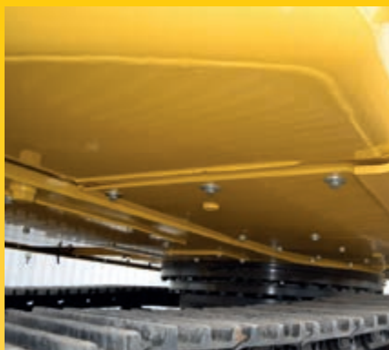
HD-Bauchschutz (9 mm) unter dem ganzen Oberwagen für erhöhten Schutz vor Beschädigungen durch Material am Boden
