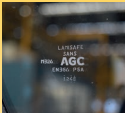
Front- und Dachscheibe aus Verbundsicherheitsglas (nach EN356 P5A); Scheibenwisch-/waschanlage für Dachscheibe als Standardausrüstung
