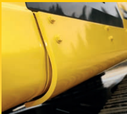
Gebogene seitliche Panzerbleche (15 mm), geschraubte Ausführung, zum optimalen Schutz vor Beschädigungen von unten oder von den Seiten
