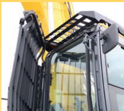
Klappbares FOPS-Frontschutzgitter für einfache Reinigung der Scheibe; Demolition Safety SpaceCab™-Abbruchkabine mit ROPS nach ISO 12117.2:2008
