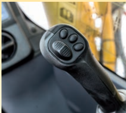
Joysticks mit Proportionalsteuerung für Anbaugeräte
