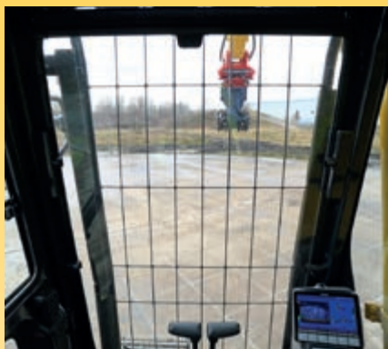
Sorgfältig angepasstes Schutzgitter ermöglicht maximale Sicht und ordnungsgemäßen Schutz; einteiliges Frontschutzgitter und Frontscheibe aus Verbundsicherheitsglas
