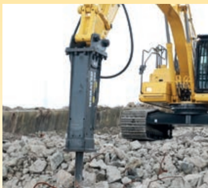
Das optional verfügbare System zur Steuerung von Hydraulikölstrom und -druck für Anbaugeräte speichert Voreinstellungen für bis zu 15 Anbaugeräte und stellt sicher, dass diese mit maximaler Effizienz eingesetzt werden können
