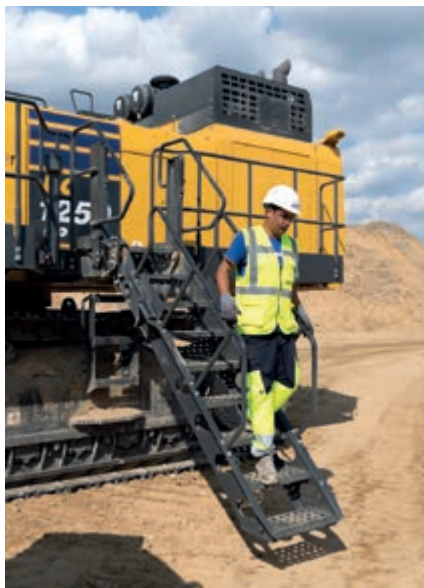
Pour accéder à la cabine et en sortir, un escalier à entraînement hydraulique est prévu de série.
