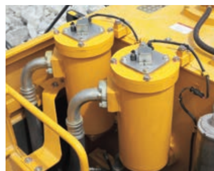
Indicateur de colmatage dans le filtre de vidange hydraulique évitant les dommages du système hydraulique
