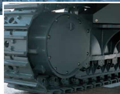
Protections robustes des moteurs de déplacement et protecteurs de rocs
