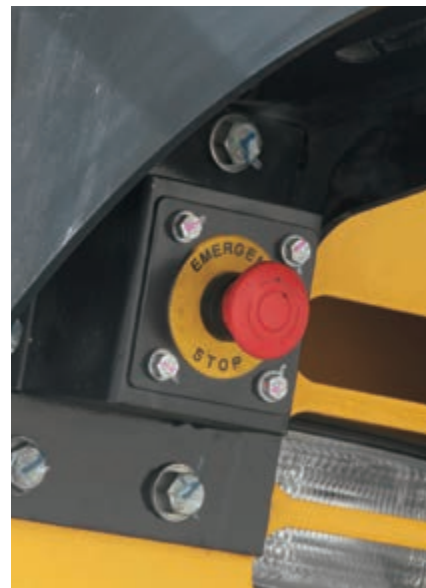
Tre interruttori d'emergenza per l'arresto del motore sono installati di serie in cabina e attorno alla macchina.
