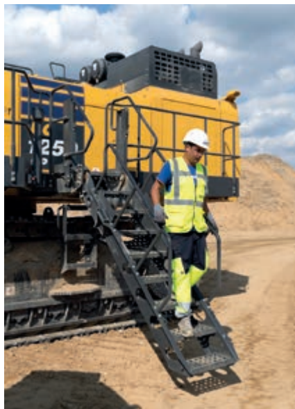
La scala azionata idraulicamente offre una maggiore sicurezza di entrata e di uscita dalla macchina.
