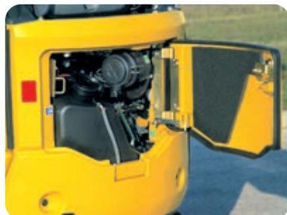
Capot arrière: contrôle rapide des éléments du moteur et remplissage gasoil
