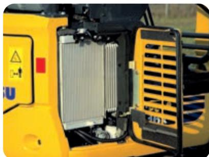
Capot latéral droit: simple inspection et nettoyage des radiateurs
