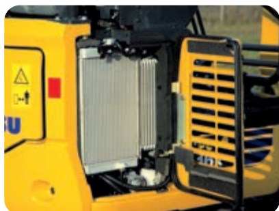
Cofano destro: ispezione e pulizia dei radiatori
