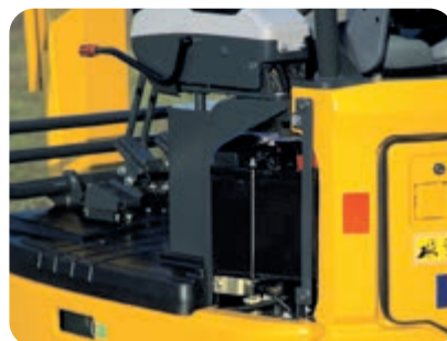
Cofano sinistro: accesso alla batteria
