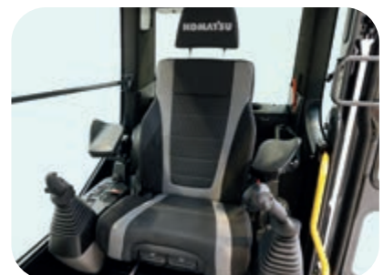
Optionaler Premium-Fahrersitz mit hochwertigen Kissen, automatischer Gewichtsanzpassung, Lendenwirbelsäulenstütze, Klimaautomatik, verfügbar auch mit optionalen verstellbaren Armstützen und ergonomischen Bedienhebeln
