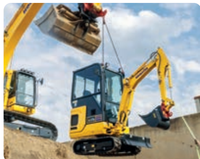
Sollevamento rapido e semplice mediante funi, senza bisogno di ulteriori attrezzi
