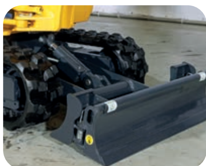
Lama pieghevole per l'adattamento alla carreggiata variabile del sottocarro
