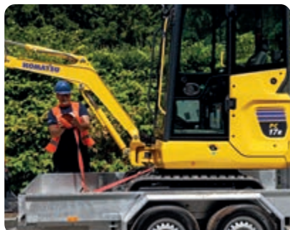
Punti di ancoraggio sulla torretta aiutano a fissare rapidamente la macchina per il trasporto
