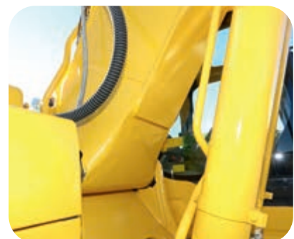
Pied de flèche en acier moulé et plaque de dessous de flèche d'une seule pièce
