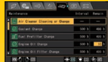
Écran de base de maintenance
