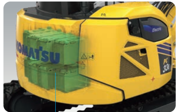
Area ad alta tensione
