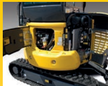
Cofani posteriori per controllo del motore, rifornimento carburante, ispezione e pulizia dei radiatori ed accesso alla batteria
