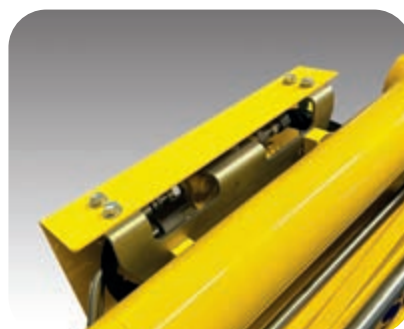
Clapets de sécurité sur vérins de flèche et de balancier
