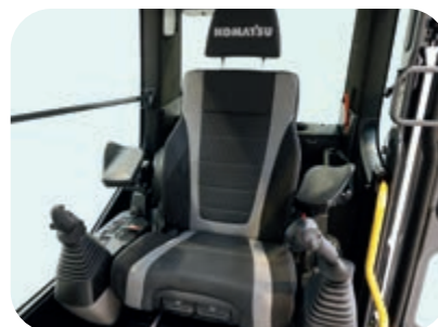
Siège premium en option, avec une assise de grande qualité, réglage automatique du poids, soutien lombaire, climatisation, et possibilité d'accoudoirs repositionnables et de leviers de commande ergonomiques
