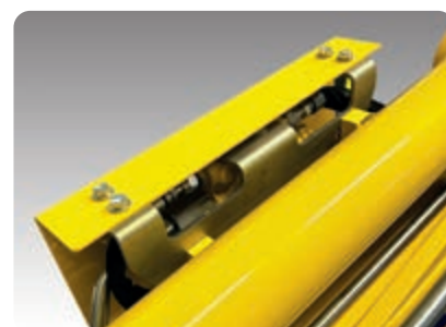
Clapets de sécurité sur vérins de flèche et de balancier
