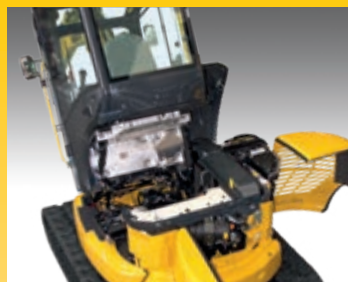
La manutenzione straordinaria può essere effettuata semplicemente ribaltando la cabina
