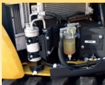
Grande filtro e prefilto del carburante con separatore di acqua per proteggere il motore
