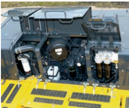
Accès aisé aux filtres sous la partie frontale du capot moteur
