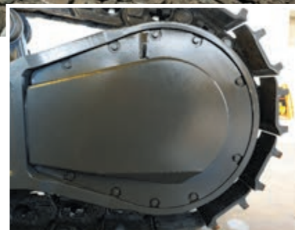
Protections robustes des moteurs de déplacement
