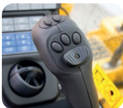
Manipulateur avec commandes précises, pratiques et ergonomiques
