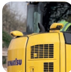
Systèmes de caméras avec vue arrière et latérale (de série)
