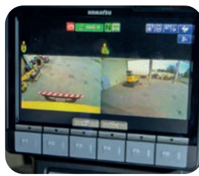
Systèmes de caméras avec vue arrière et latérale
