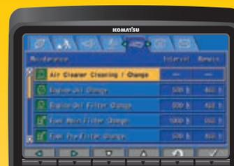
L'écran de maintenance sur le système de contrôle vous indique quand l'huile et les filtres doivent être remplacés.
