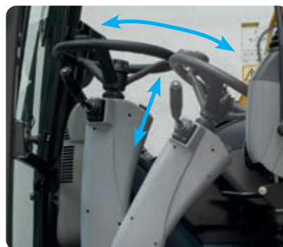
Le volant télescopique de série s'adapte facilement à la taille et à l'envergure de chaque opérateur
