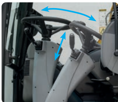
Il volante telescopico di serie è comodamente regolabile in altezza e sbraccio
