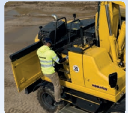
Corrimano e piastre antisdrucchio per un accesso comodo e sicuro ai punti di manutenzione
