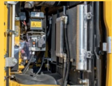
Side-by-Side Kühler für einfachsten Zugang zur Reinigung
