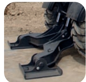
Schild-/Pratzenzylinder mit integriertem Rückschlagventil (Standard)
