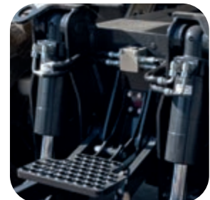
Schild-/Pratzenzylinder mit integriertem Rückschlagventil (Standard)
