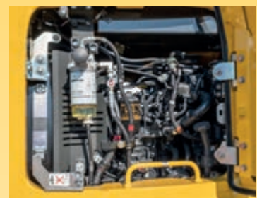
Zentral angeordnete Filter
