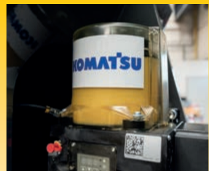
Die Zentralschmieranlage ab Werk reduziert die täglich anfallenden Wartungsarbeiten auf ein absolutes Minimum (optional).
