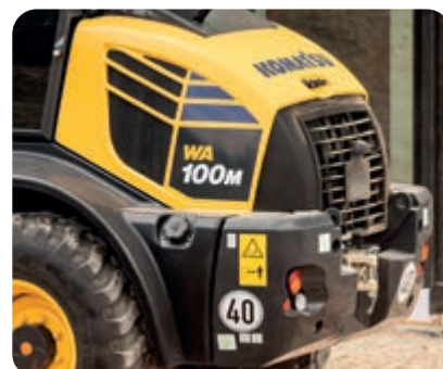
Schnellläuferversion mit 40 km/h hydrostatischem Antrieb (optional)
