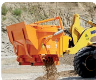
High-Flow-Version mit max. 120 l/min bei 210 bar (optional)
