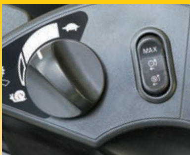
Commande de changement de vitesses variable avec nouvelle plage de vitesse d'approche lente (gauche) et commutateur de limiteur de couple (TCS) variable (droite)
