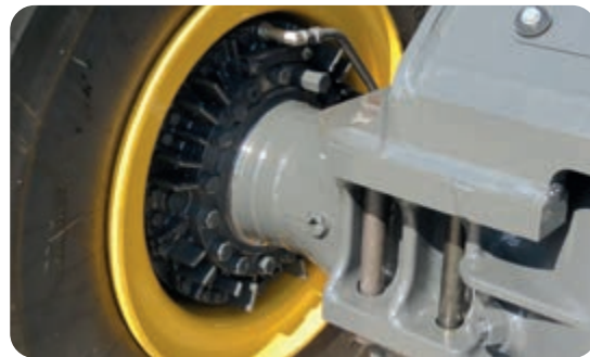
Système de refroidissement d'huile de ponts
