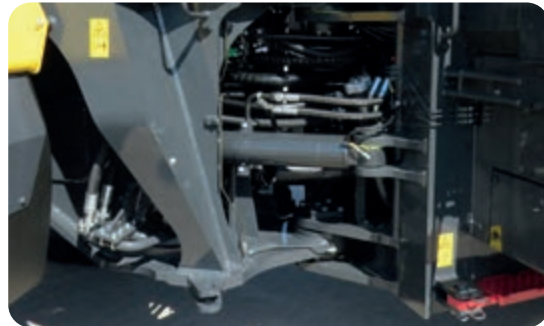
Perno cerniera centrale rinforzato, cilindri di sterzo maggiorati e impianto idraulico adattato
