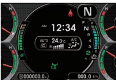
Auf einen Blick: Standardanzeige des Monitorsystems
