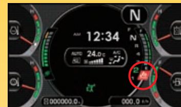
AdBlue®-Füllstandanzeige und Nachfüllhinweis
