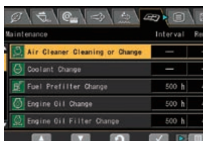
Ein Multifunktionsmonitorsystem ermöglicht die Anzeige und Einstellung von zahlreichen Betriebs- und Wartungsdaten
