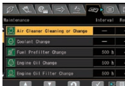
Un écran multifonctions affiche et contrôle de nombreuses informations d'utilisation et d'entretien
