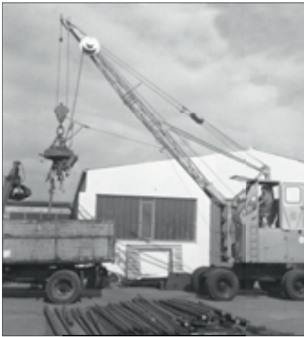
1962: Seilbetriebener S833 mit erhöhter Fahrerkabine
