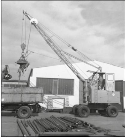
1962: Seilbetriebener S833 mit erhöhter Fahrerkabine
