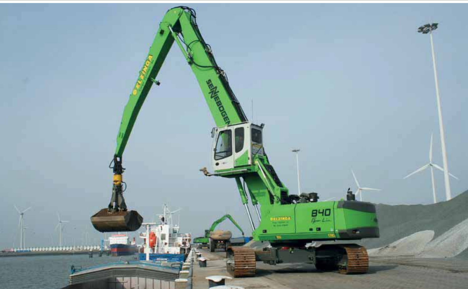
840 Crawler - K20-equipment, gravel handling, Multitool for fast grab changes; Netherlands 840 Raupe - Ausrüstung K20, Kiesumschlag, Multitool für schnellen Greiferwechsel; Niederlande
