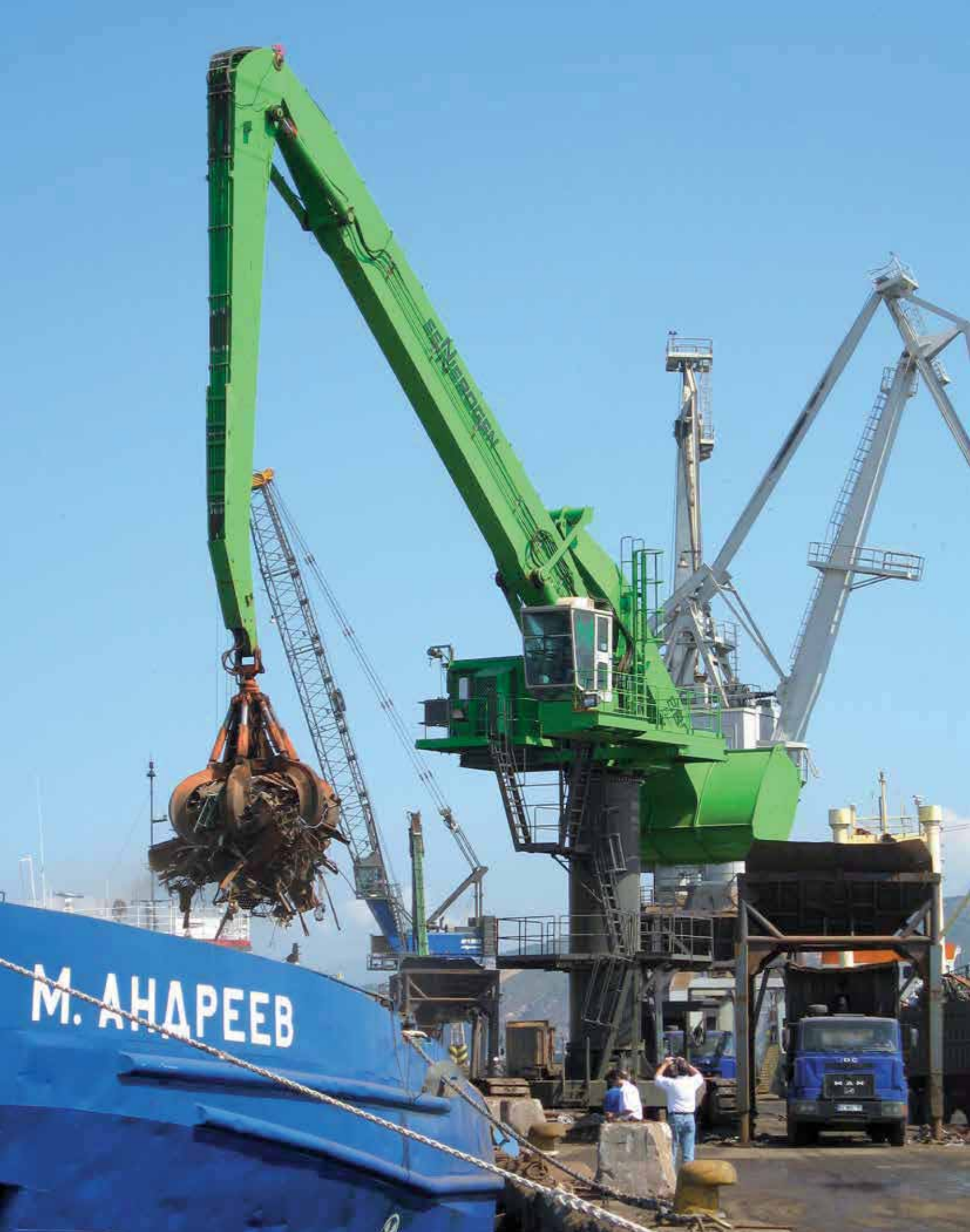
880 EQ R - 7 m pylon - equipment K33 - 8.000 litre orange-peel grab; Turkey 880 EQ R - 7 m Pylon - Ausrüstung K33 - 8.000 Liter Mehrschalengreifer; Türkei
