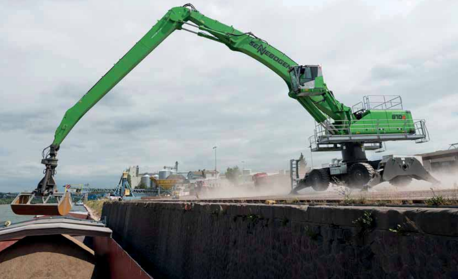
870 Mobile - Bulk material handling; Germany 870 Mobil - Schüttgutumschlag; Deutschland
