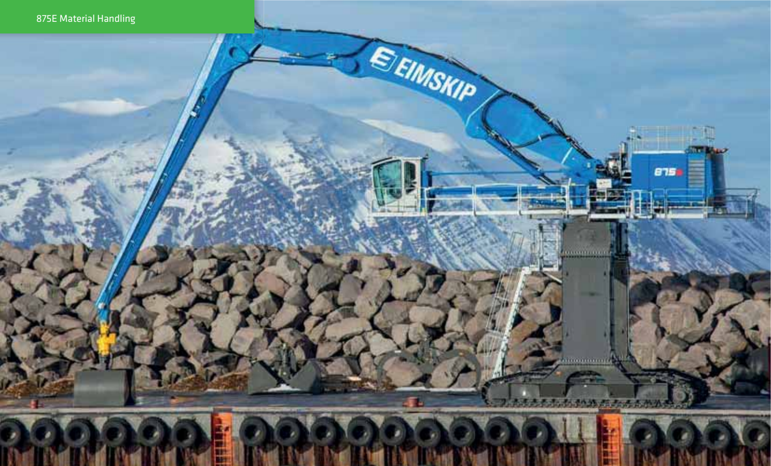
875 Crawler Gantry with port stick equipment for increased load capacities; Iceland 875 Raupe Portal mit Hafenausrüstung für mehr Traglast; Island
