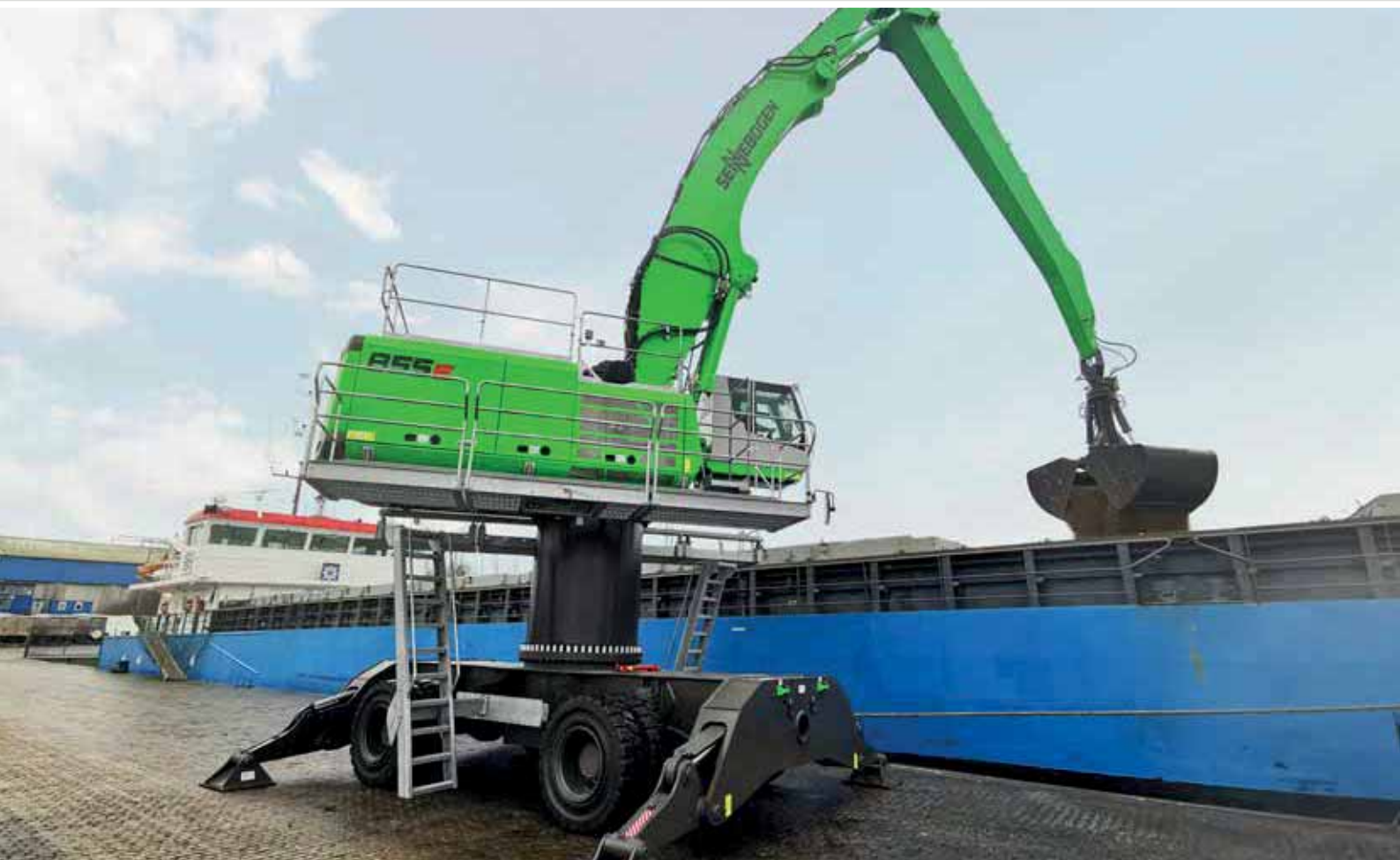
855 M - with clamshell grab - testing yard; Germany 855 M - mit Zweischalengreifer - Testgelände; Deutschland
