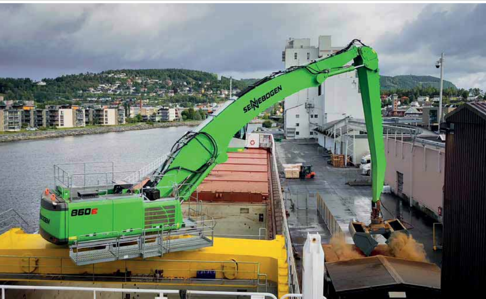
860 Hybrid E-Series - flexible installation on a trolley crane over the ship's loading area; Norway 860 Hybrid E-Serie - flexible Laufkatzenkonstruktion über dem Ladebereich eines Schiffs; Norwegen
