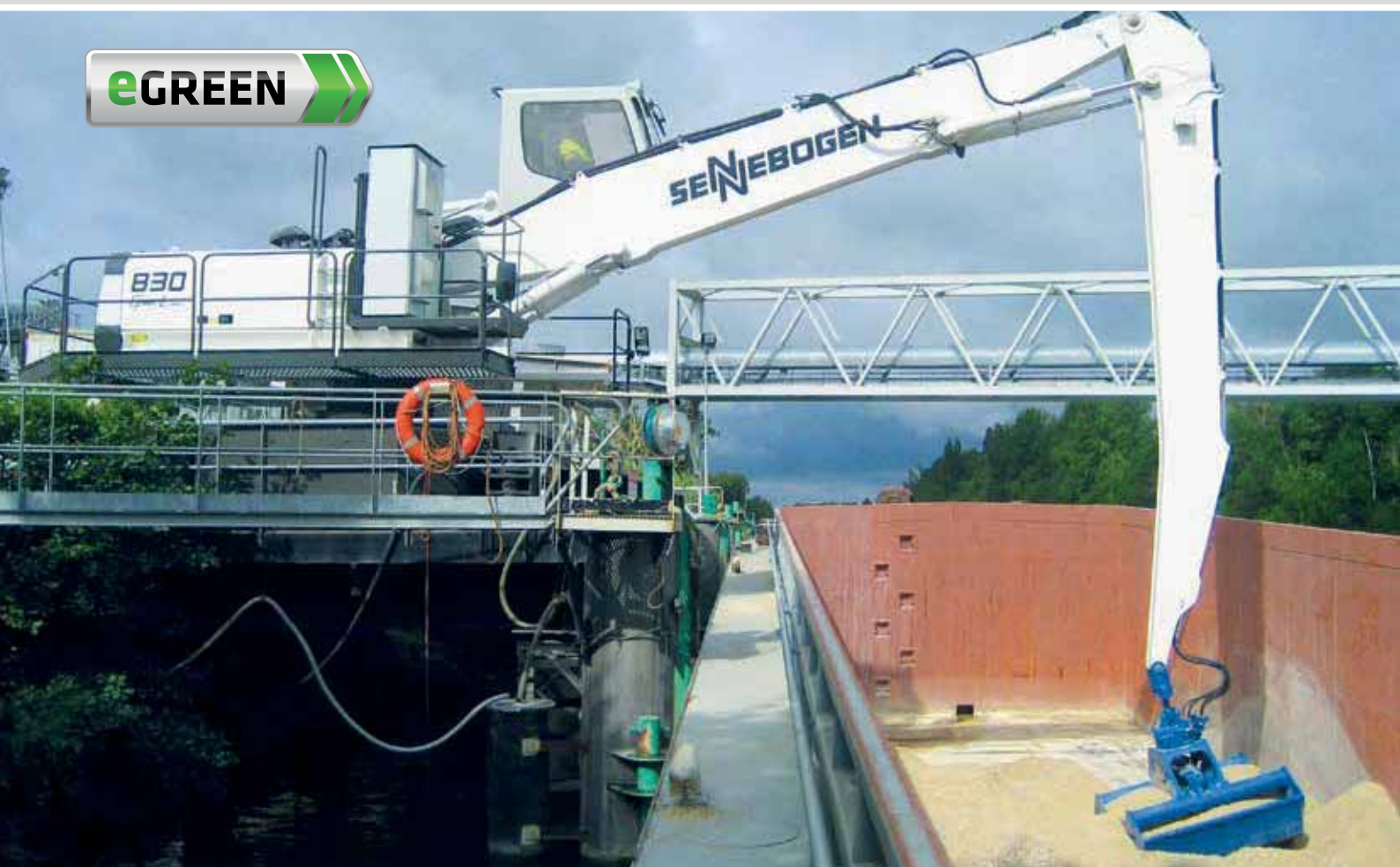
830 Electro on 4-point-pedestal - K15-equipment, sand and gravel handling; France 830 Elektro auf 4-Punkt-Untergestell - Ausrüstung K15, Sand- und Kiesverladung; Frankreich
