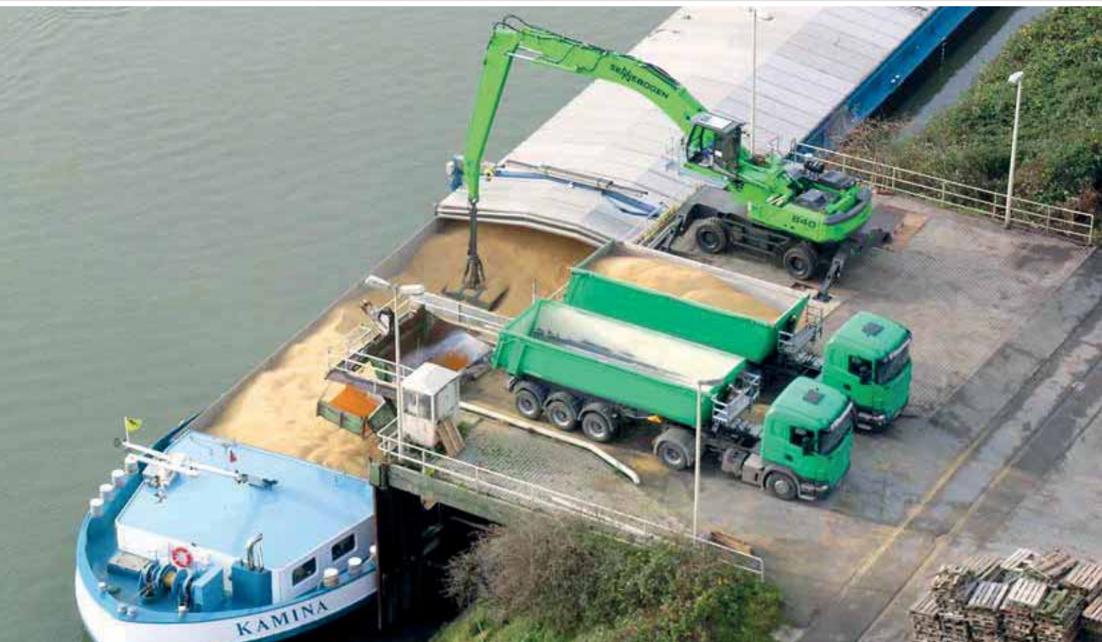
840 Mobile - B17-equipment with clamshell grab, sand handling; Germany 840 Mobil - Ausrüstung B17 mit Zweischalengreifer, Sandumschlag; Deutschland
