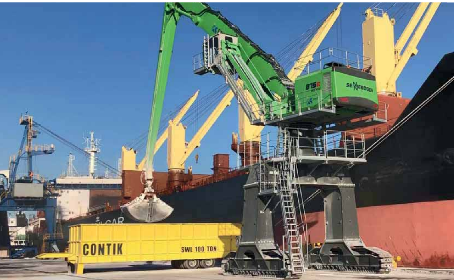
875 Crawler Gantry - with Skylift cab elevation for the perfect view into the ship's hull while handling bulk material; Finland 875 Raupenportal - mit Skylift-Kabinenerhöhung für die perfekte Sicht in den Schiffsrumpf beim Umschlag von Schüttgut; Finnland
