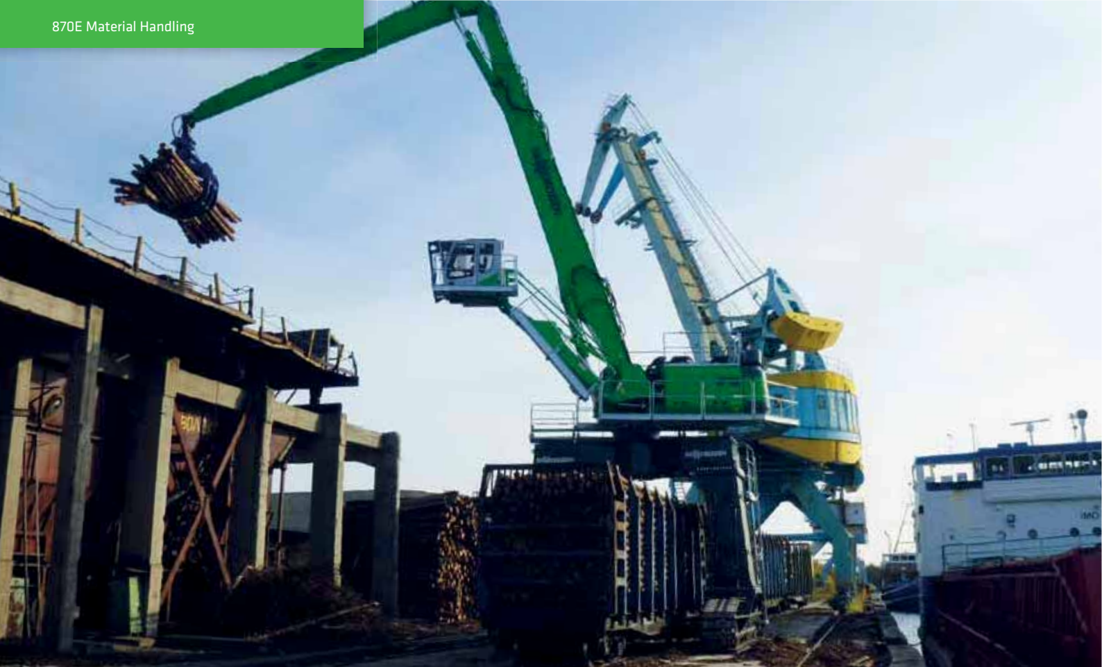
870 Crawler Gantry - K24-equipment, unloading timber from barges and wagons; Russia 870 Raupe Portal - Ausrüstung K24, Holzentladung von Binnenschiffen und Waggons; Russland
