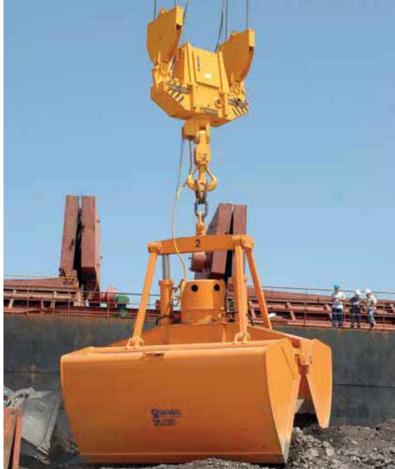
Clamshell grab on electric slewing unit (hook) for coal handling Zweischalengreifer am elektrischen Drehhaken für den Kohleumschlag
