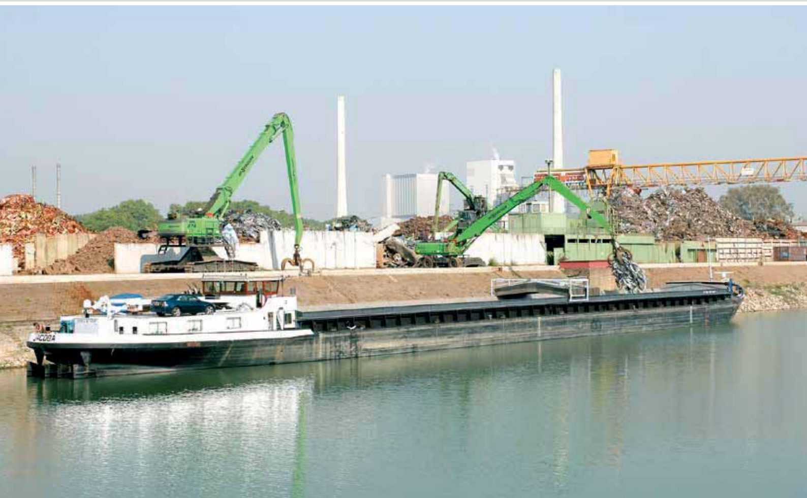
850 Mobile - K21-equipment with orange peel grab, scrap handling; Germany 850 Mobil - Ausrüstung K21 mit Mehrschalengreifer, Schrottschlag; Deutschland
