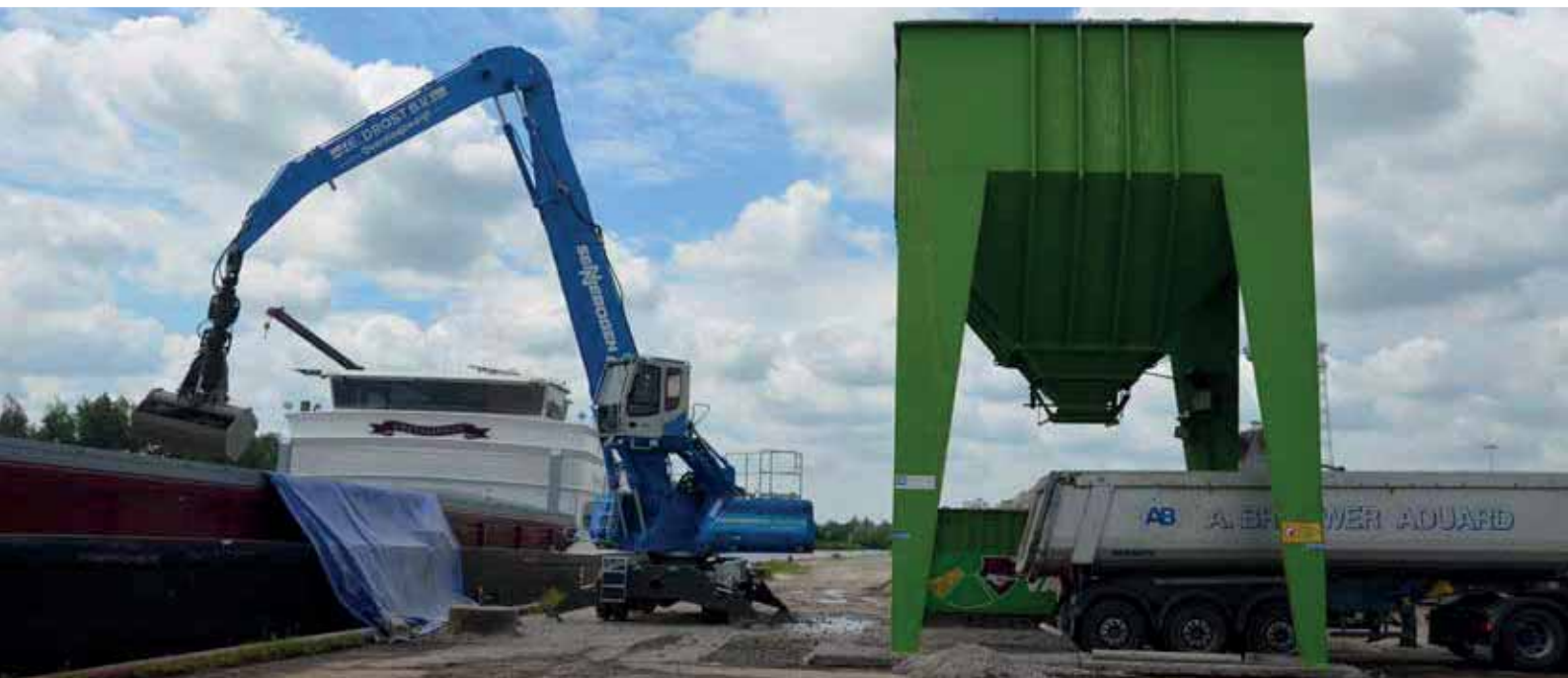
835 Mobile - K18-equipment, gravel handling in 14 m hopper; Netherlands 835 Mobil - Ausrüstung K18, Kiesverladung in 14 m hohen Trichter; Niederlande
