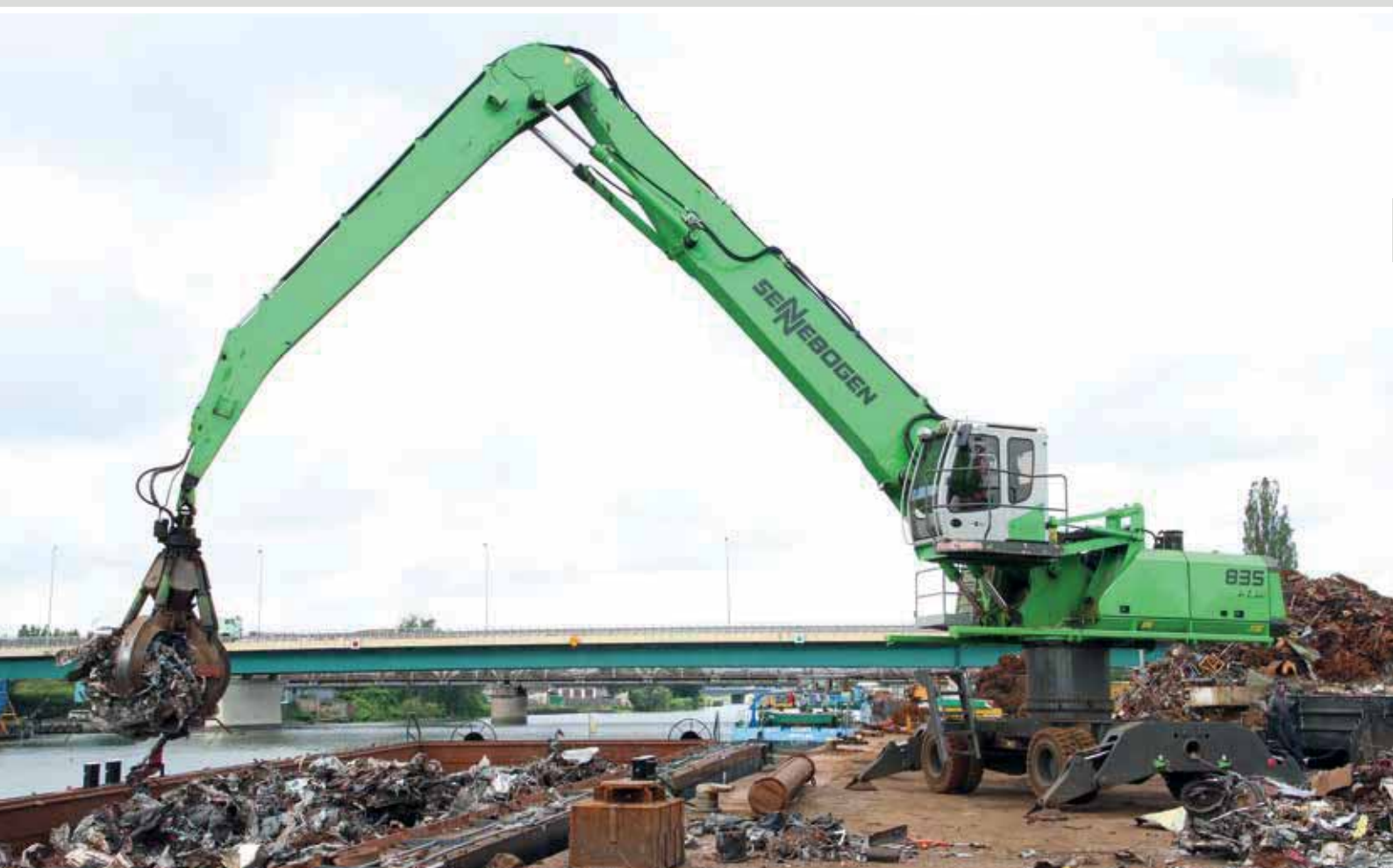
25 835 Mobile - 1,5 m pylon, K20-equipment, scrap handling; Poland 835 Mobil - 1,5 m Pylon, Ausrüstung K20, Schrottschlag; Polen
