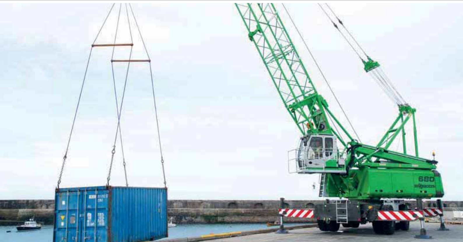
680 HMC (today 2200 HMC) - 26 m reach, container handling in lifting mode; UK 680 HMC (heute 2200 HMC) - 26 m Reichweite, Containerumschlag im Hakenbetrieb; Großbritannien
