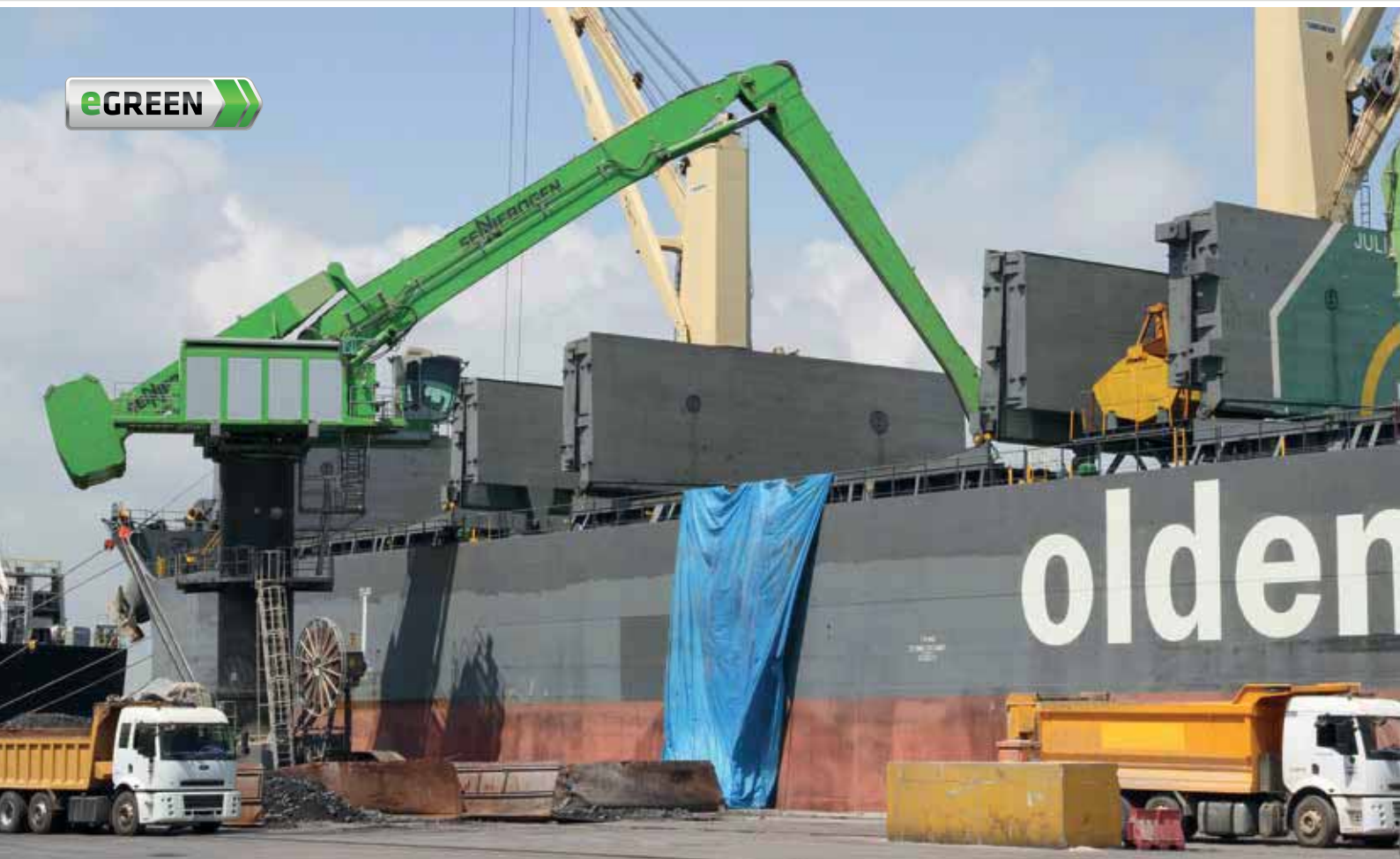
880 EQ R special - 6 m pylon - equipment K25 - Multitool with lifting device; Great Britain 880 EQ R Spezial - 6 m Pylon - Ausrüstung K25 - Multitool mit Traverse; Großbritannien
