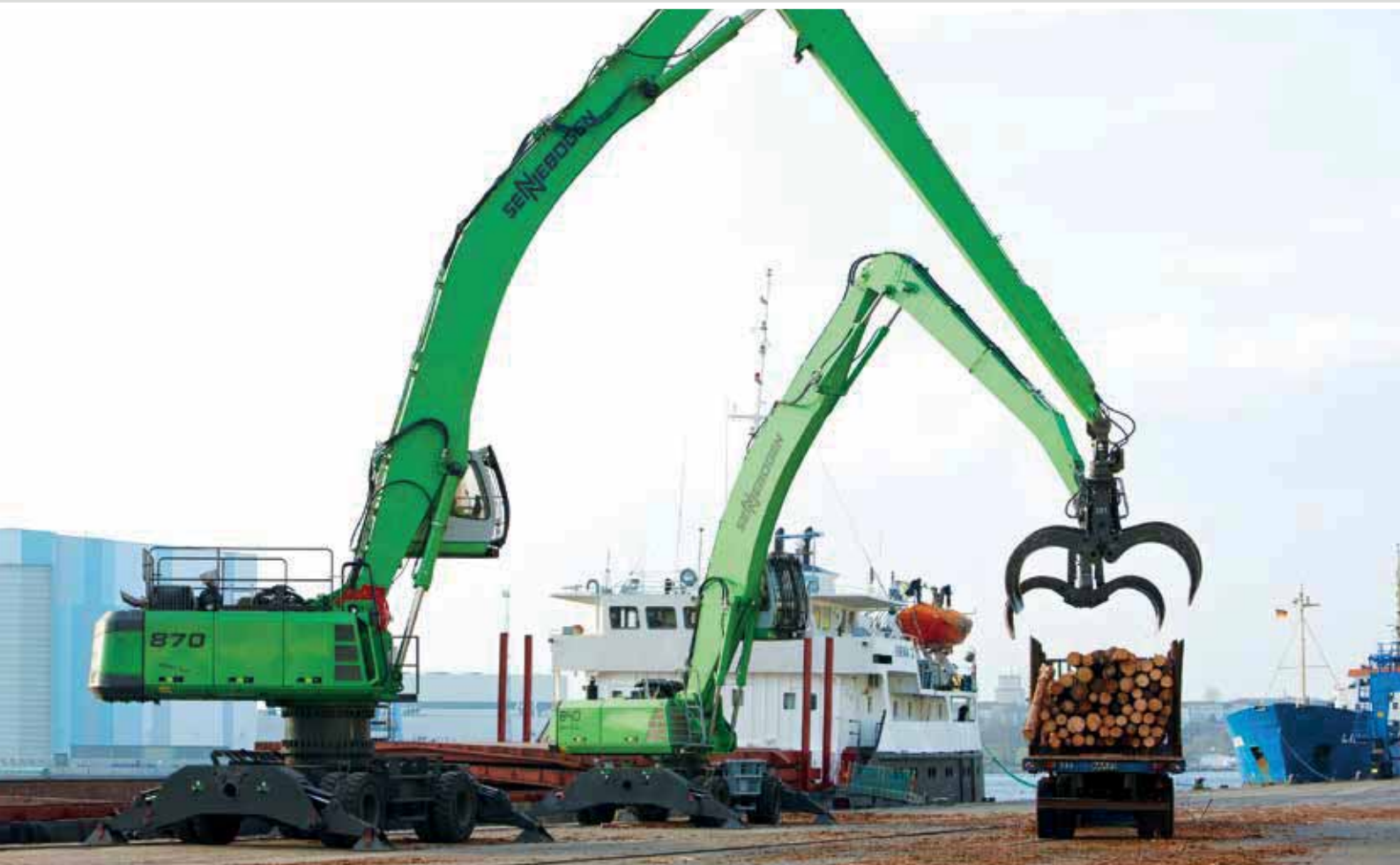
870 Mobile - log handling in a Baltic sea port; Germany 870 Mobil - Holzumschlag in einem baltischen Seehafen; Deutschland
