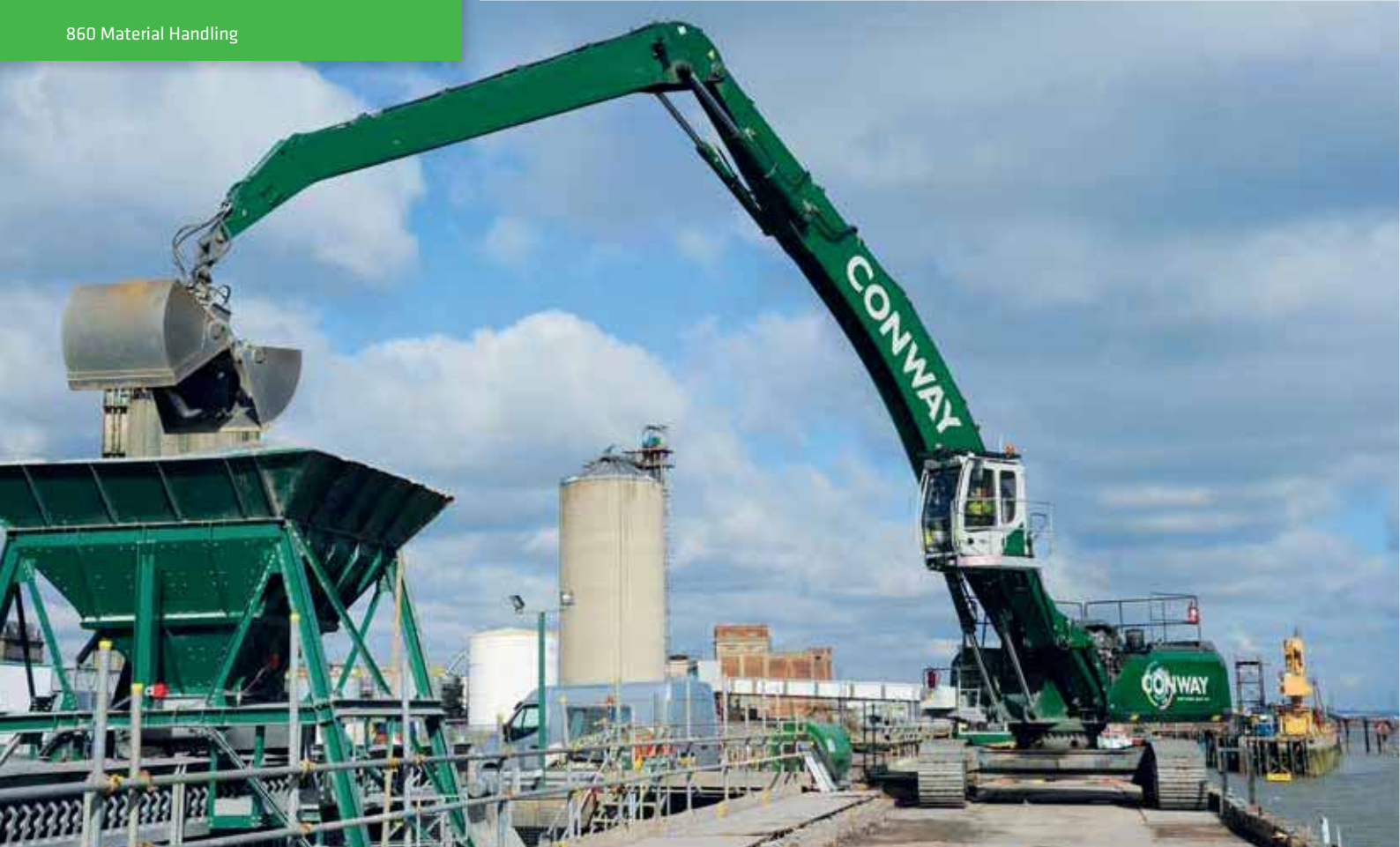
860 Crawler - B21-equipment with clamshell grab, gravel handling; UK 860 Raupe - Ausrüstung B21 mit Zweischalengreifer, Kiesverladung; Großbritannien
