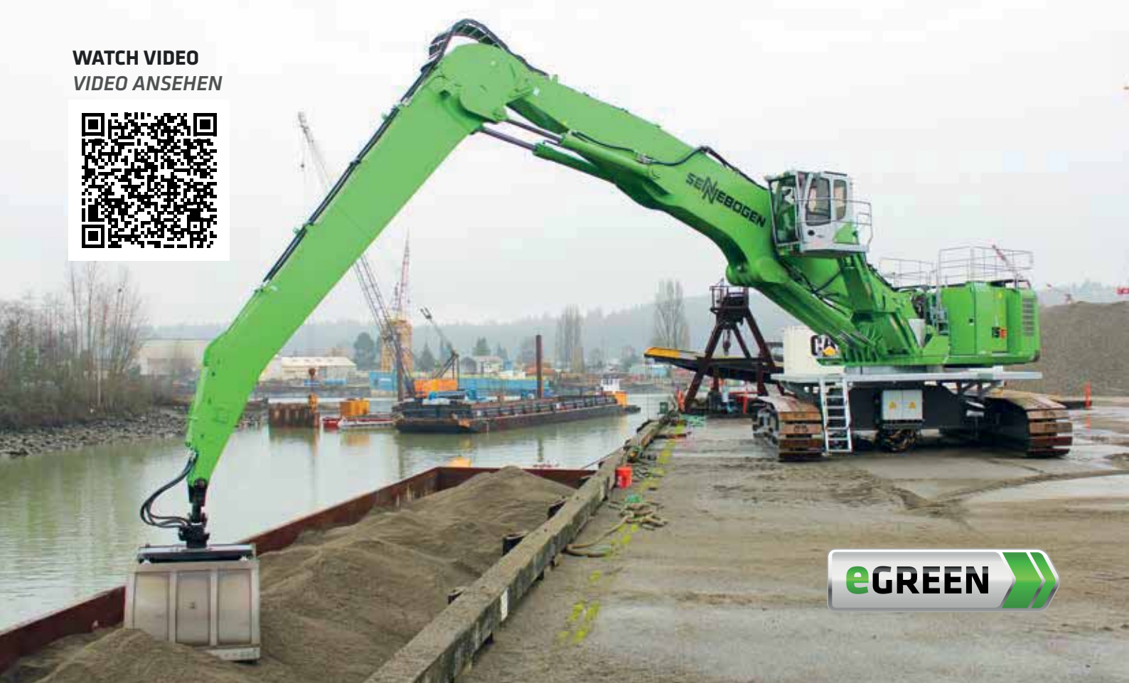
875 Crawler Electro - K21-equipment with clamshell grab, sand and gravel handling; USA 875 Raupe Elektro - Ausrüstung K21 mit Zweischalengreifer, Sand- und Kiesumschlag; USA
