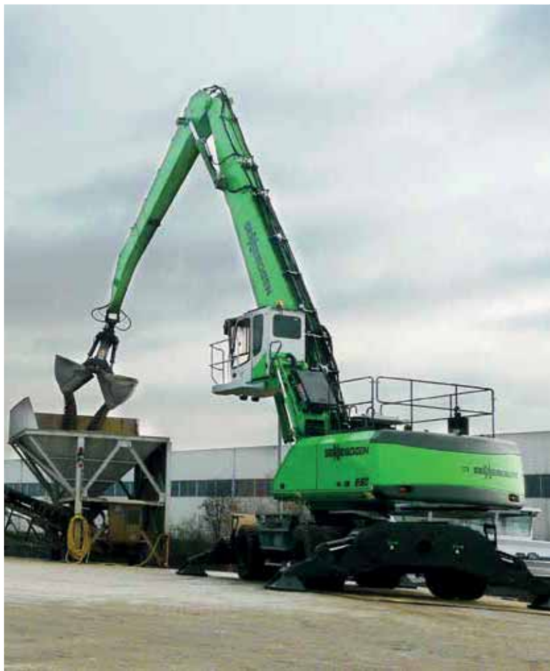
860 Mobile - K21-equipment with clamshell grab, sand and gravel handling; Netherlands 860 Mobil - Ausrüstung K21 mit Zweischalengreifer, Sand- und Kiesumschlag; Niederlande
