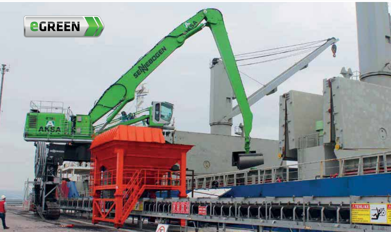
875 Electro Crawler Gantry - coal handling with clamshell grab; Turkey 875 Elektro Raupe Portal - Kohleumschlag mit Zweischalengreifer; Türkei
