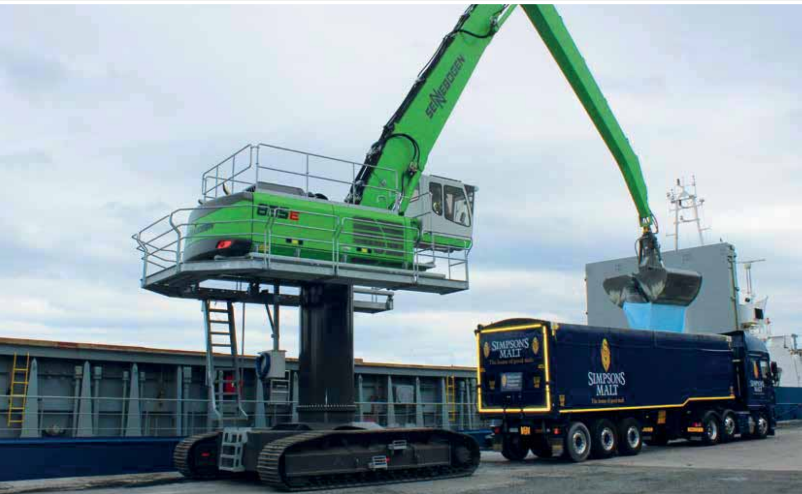
835 Crawler - 3 m pylon, K20-equipment with clamshell grab, fertilizer handling; UK 835 Raupe - 3 m Pylon, Ausrüstung K20 mit Zweischalengreifer, Düngemittelumschlag; Großbritannien
