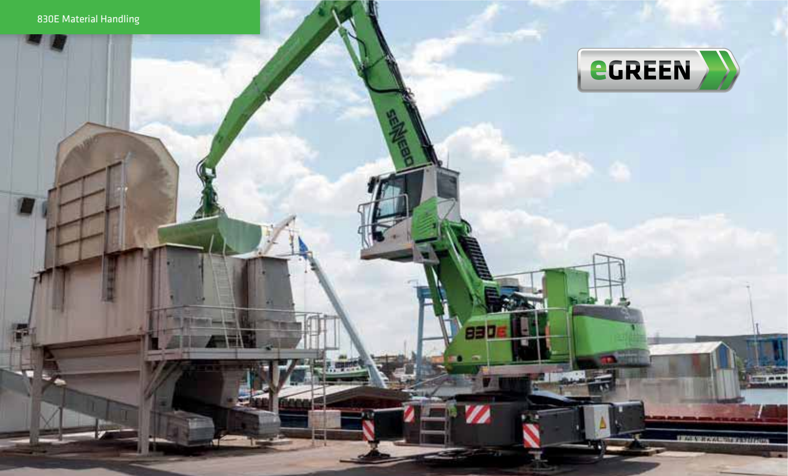
830 Electro on 4-point-pedestal - K17-equipment with clamshell grab, fodder handling; Netherlands 830 Elektro auf 4-Punkt-Untergestell - Ausrüstung K17 mit Zweischalengreifer, Futtermittelumschlag; Niederlande
