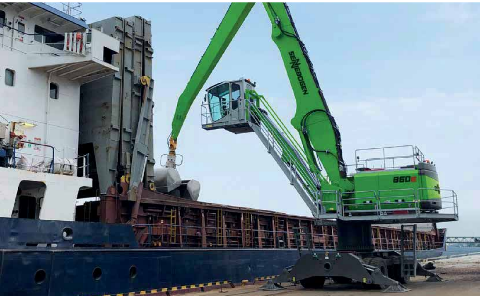
860 Mobile - with Skylift cab elevation for the perfect view into the ship's hull 860 Mobil - mit Skylift-Kabinenerhöhung für die optimale Sicht in den Schiffsrumpf hinein
