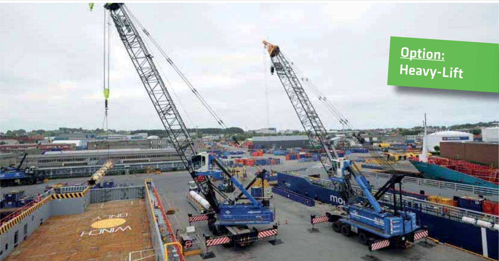
6210 HMC Heavy Lift - with additional 20 t counter weight: up to 40% higher lift capacity, loading supply cargo; Norway 6210 HMC Heavy Lift- mit zusätzlichen 20 t Gegengewicht: bis zu 40% mehr Tragfähigkeit, Verladung von Versorgungsgütern; Norwegen
