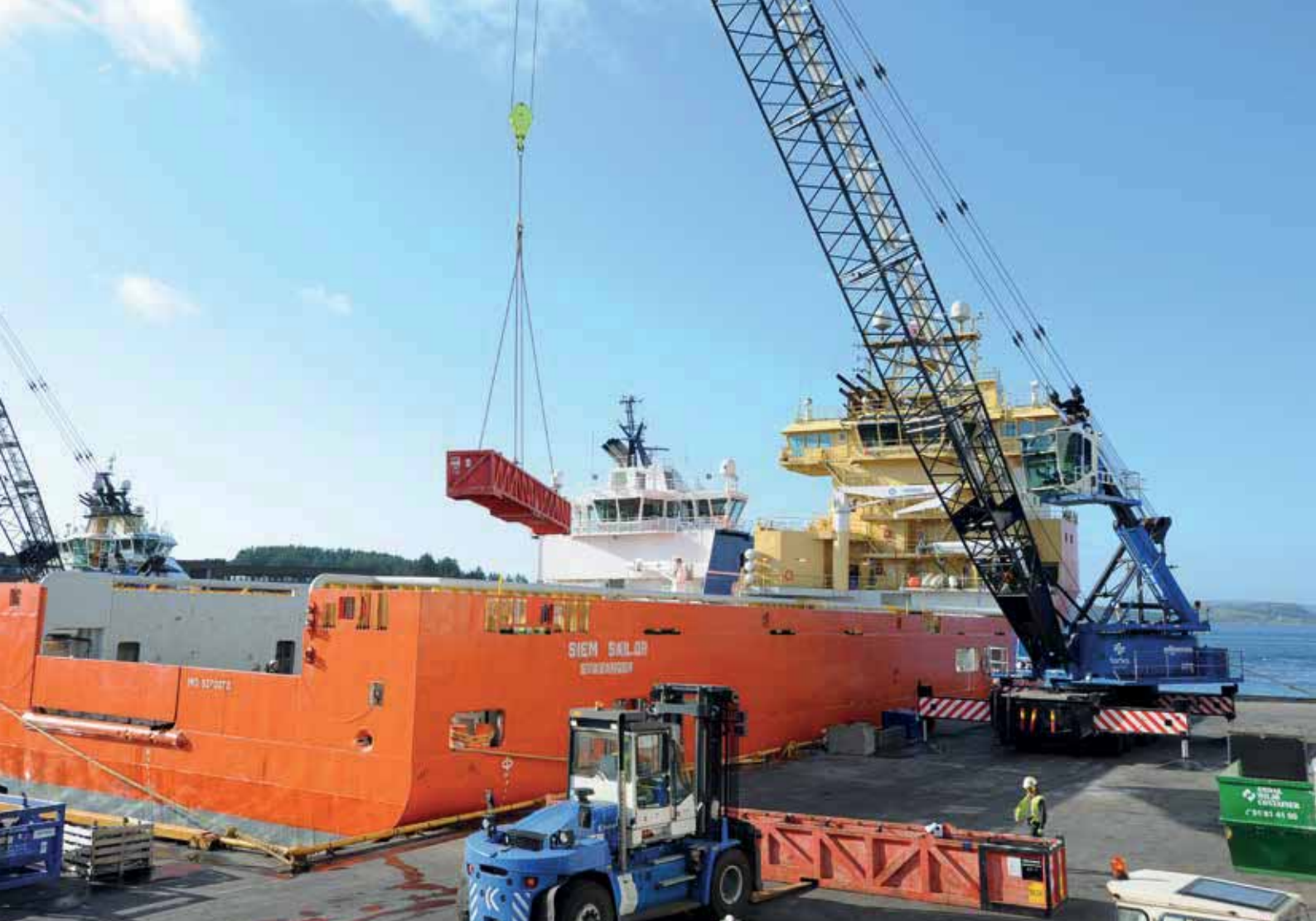
6210 HMC - 53,5 m radius , 2 x 200 kN double winch with speeds up to 103 mps, loading of supply cargo; Norway 6210 HMC - 53,5 m Ausladung, 2 x 200 kN Doppelwinde mit Geschwindigkeiten bis zu 103 m/s, Verladung von Versorgungsgütern; Norwegen
