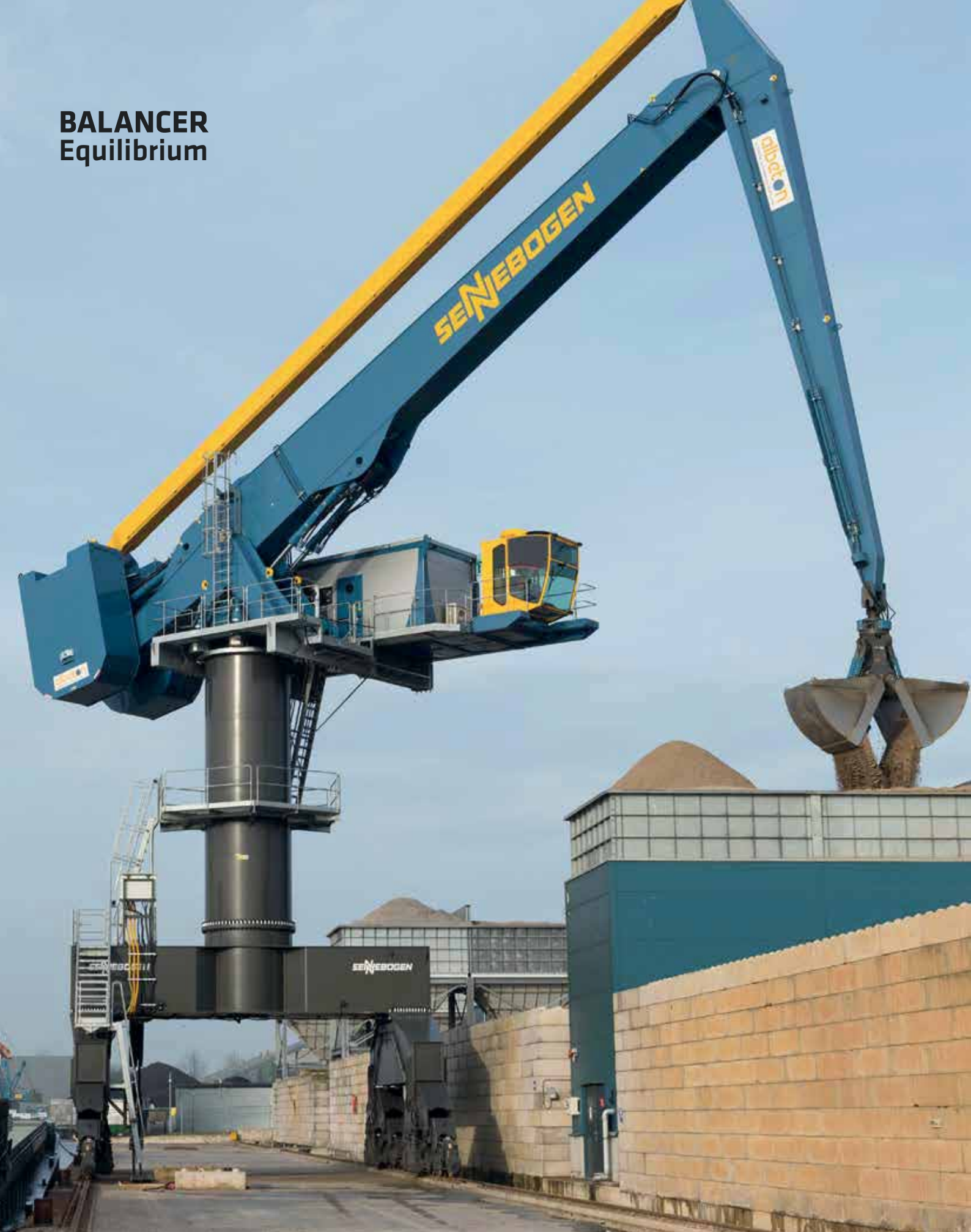
EQ Balancer - with clamshell grab - port material handling; Netherlands EQ Balancer - mit Zweischalengreifer - Hafenumschlag; Niederlande
