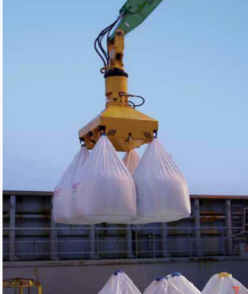
Spreader for big bag handling Spreader für den Big Bag Umschlag
