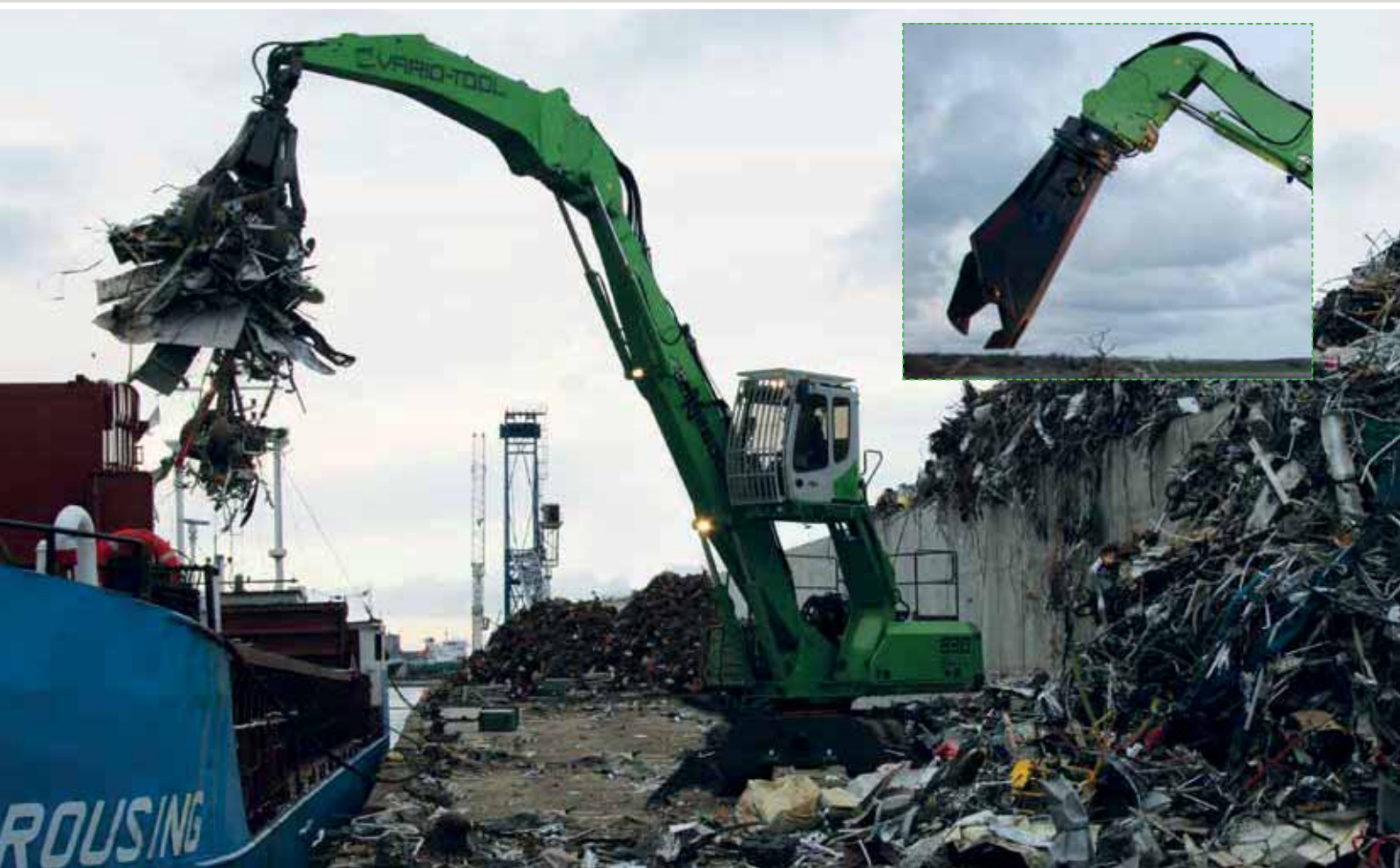
830 Mobile Vario Tool - Change attachment in 2 minutes to scrap metal shear, scrap handling; Denmark 830 Mobil Vario Tool - Werkzeugwechsel in 2 Minuten auf Schrottschere, Schrottschlag; Dänemark
