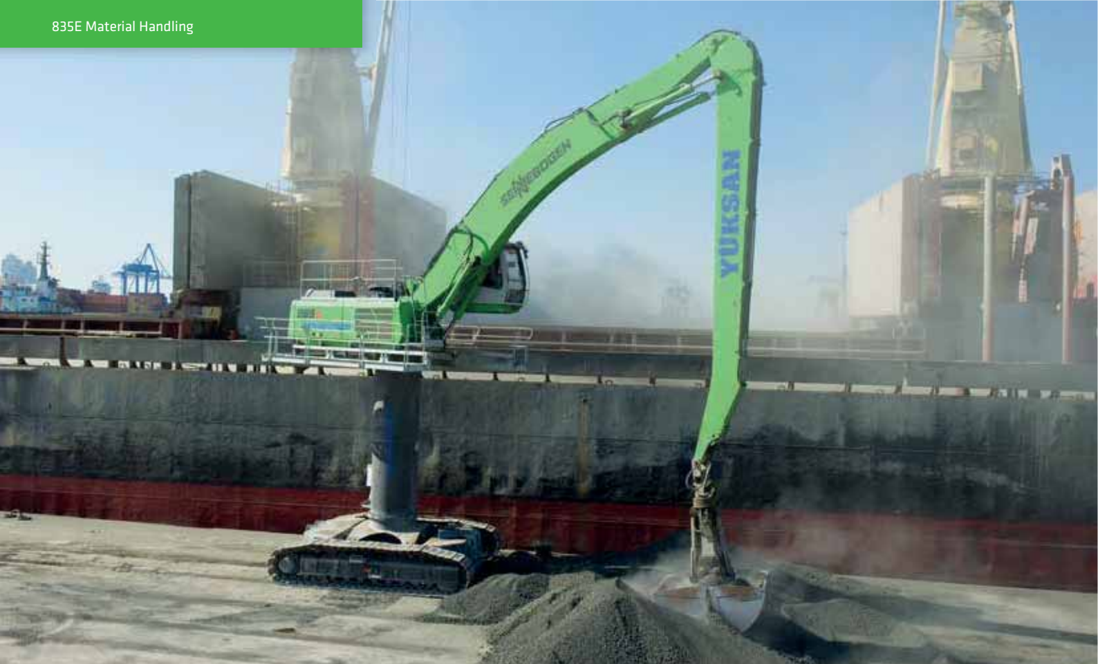
835 Crawler - 4,5 m pylon, B19-equipment with 3m 3 clamshell grab, loading ore; Turkey 835 Raupe - 4,5 m Pylon, Ausrüstung B19 mit 3m 3 Zweischalengreifer, Erzverladung; Türkei
