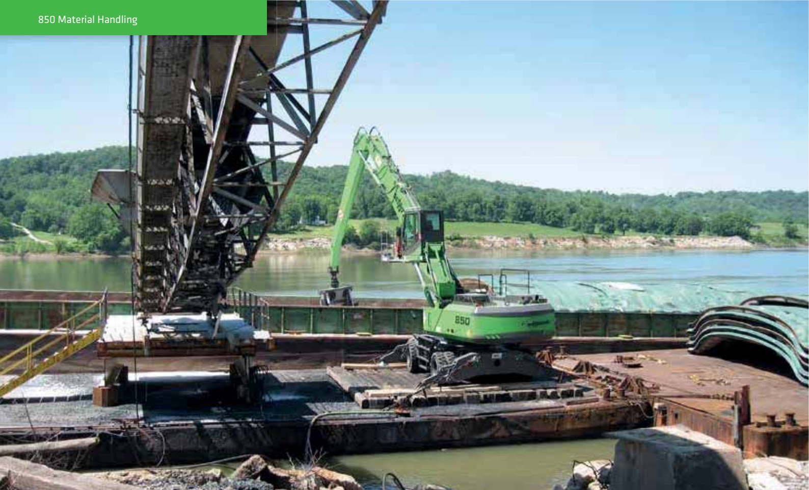
850 Mobile - K19-equipment with clamshell grab, salt handling; USA 850 Mobil - Ausrüstung K19 mit Zweischalengreifer, Salzumschlag; USA
