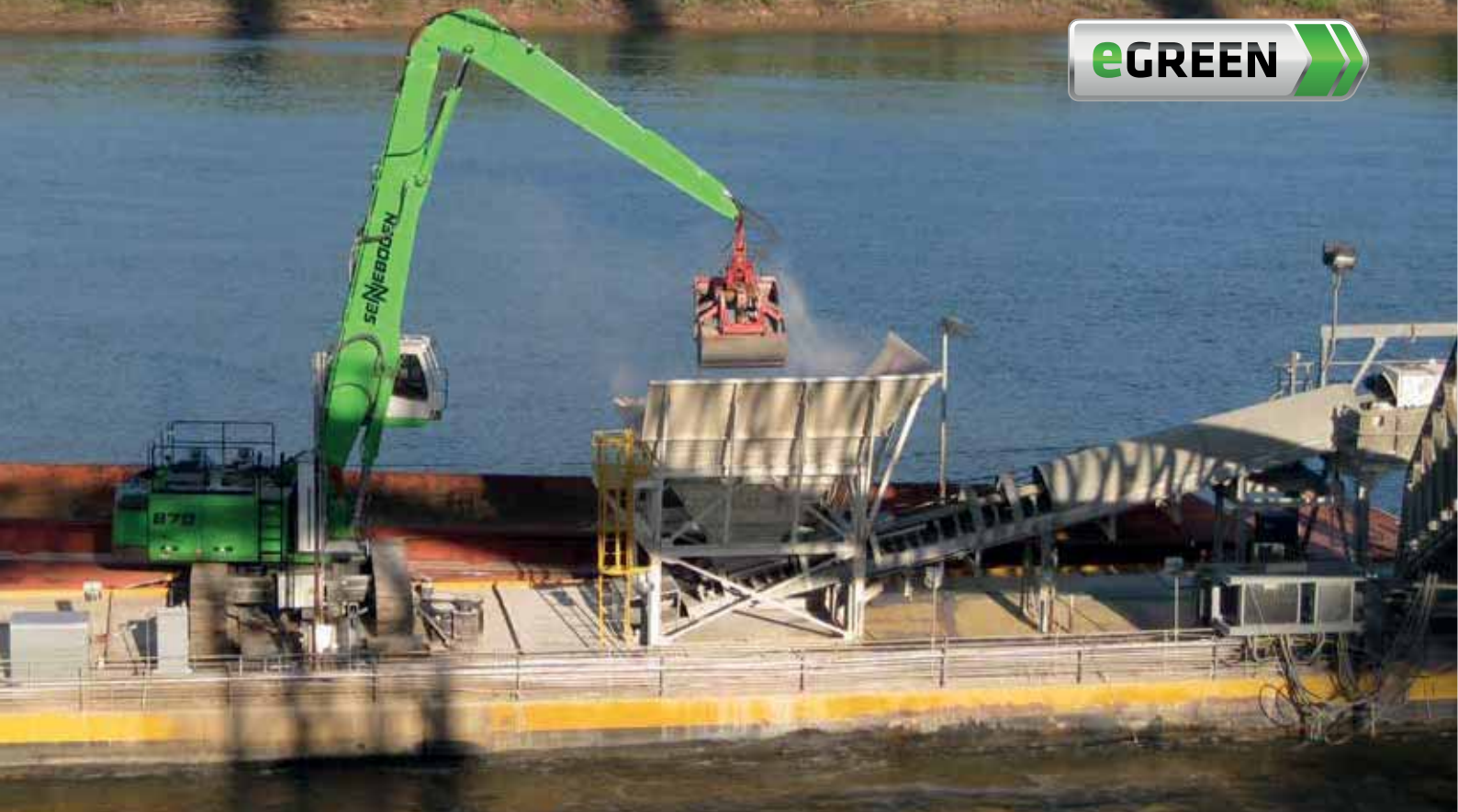
870 Crawler Electro - K20-equipment, clamshell grab, lime stone handling; USA 870 Raupe Elektro - Ausrüstung K20, Zweischalengreifer, Kalksteinumschlag; USA
