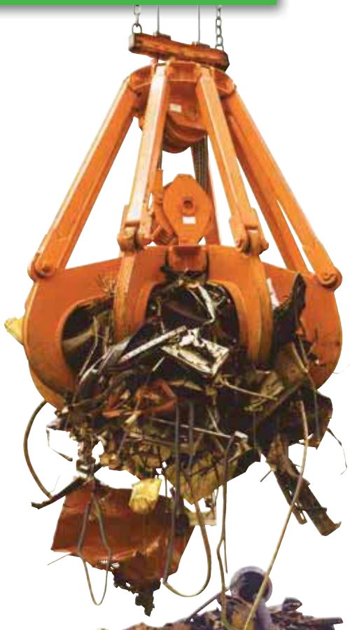
Orange peel grab for scrap metal handling Mehrschalengreifer für den Schrotturnschlag
