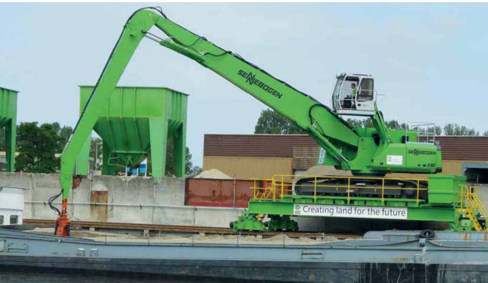
850 Crawler on rail wagon - K21-equipment with clamshell grab, sand handling; Netherlands 850 Raupe auf Schienenunterwagen - Ausrüstung K21 mit Zweischalengreifer, Sandumschlag; Niederlande
