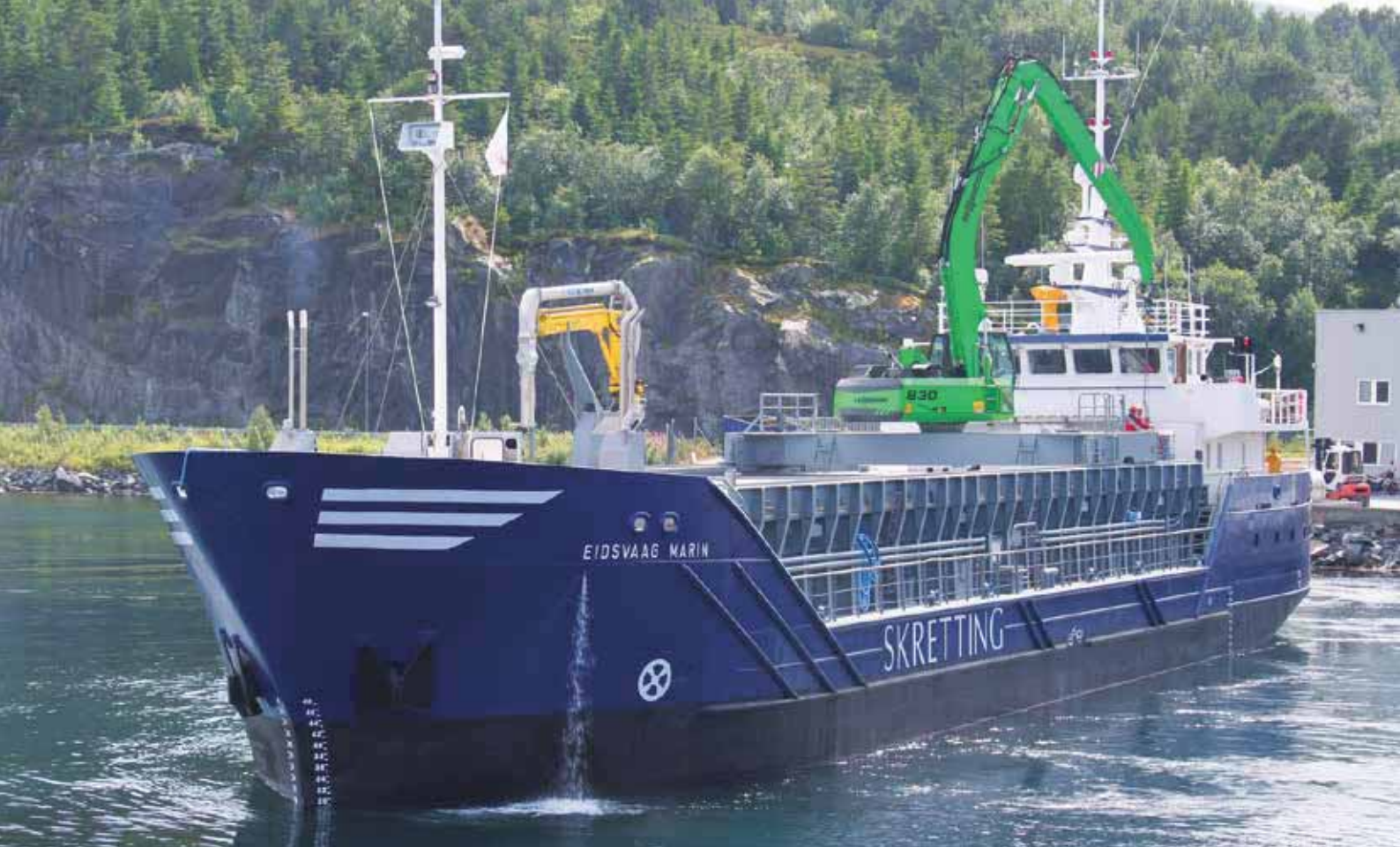
830 ship-mounted on rail gantry - B15-equipment, gravel handling; Norway 830 Schiffsaufbau auf Schienenportal - Ausrüstung B15, Kiesumschlag; Norwegen
