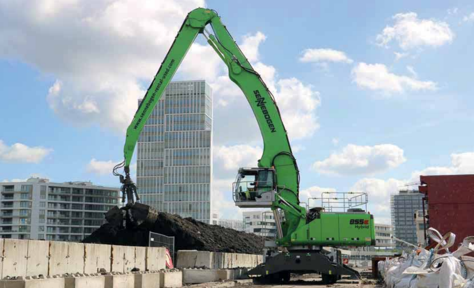
855 M - Bulk handling with clamshell grab and 20 m-equipment, type „Banana“ for reaching deeper into the ship's hull 855 M - Schüttgutumschlag mit Zweischalengreifer und 20 m-Banana-Ausrüstung für mehr Reichhöhe
