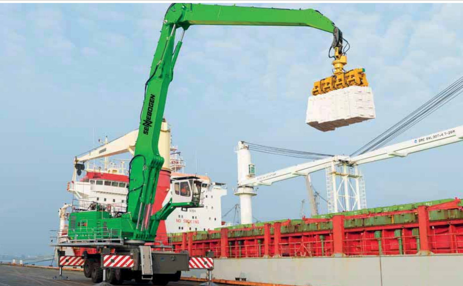
875 Mobile - K27-equipment with pulp spreader; Germany 875 Mobil - Ausrüstung K27 mit Zellstoffpaketgreifer; Deutschland
