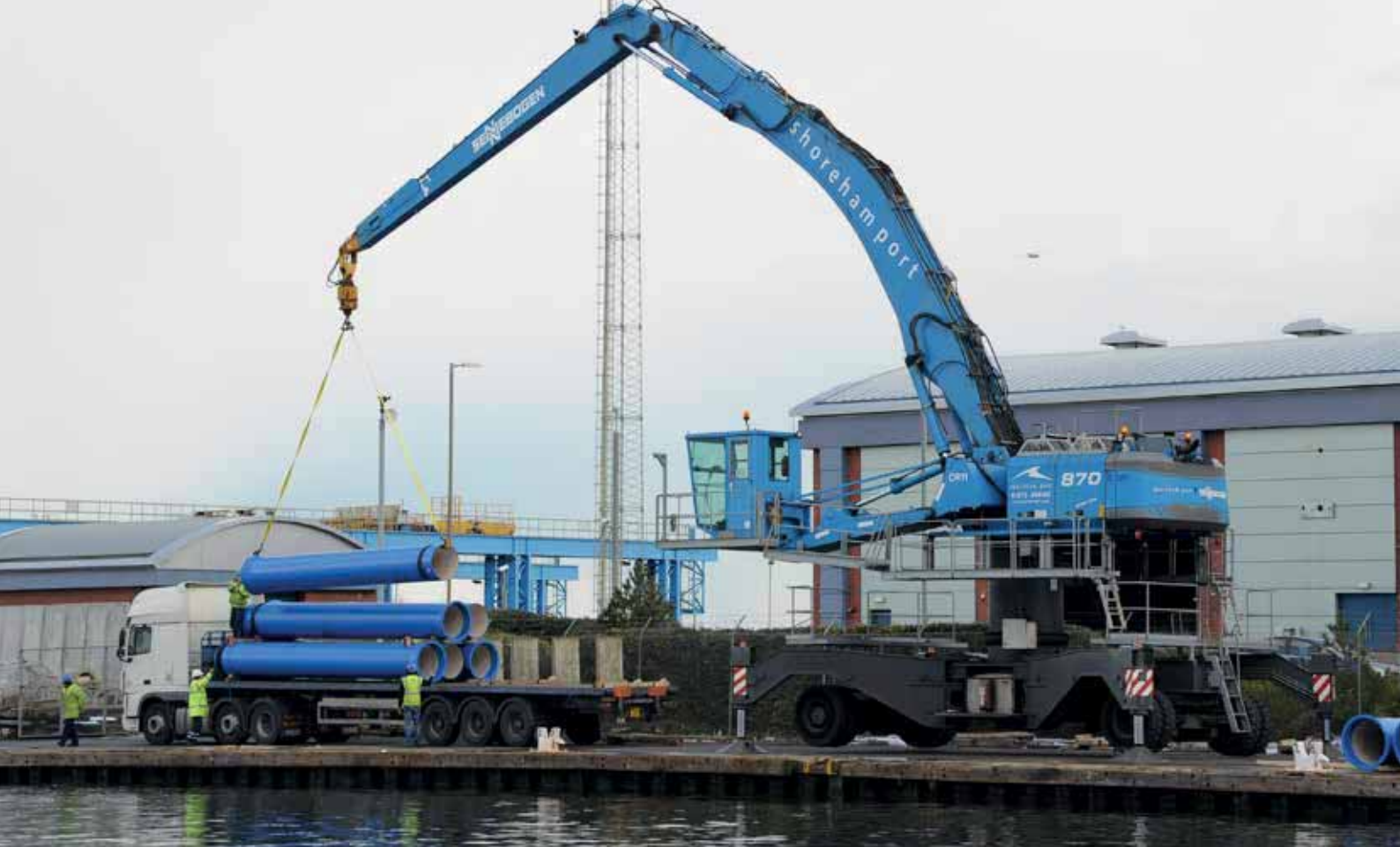
870 Mobile - Pipe handling; United Kingdom 870 Mobil - Rohrverladung; Großbritannien
