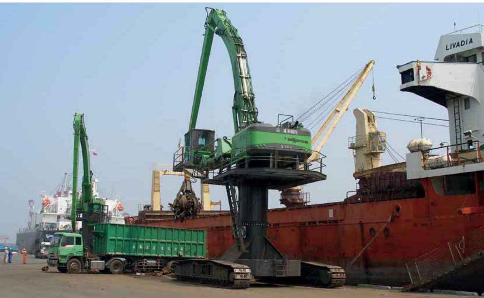
870 Crawler - 3 m pylon, B23-equipment with orange peel grab, scrap handling; Taiwan 870 Raupe - 3 m Pylon, Ausrüstung B23 mit Mehrschalengreifer, Schrottschlag; Taiwan
