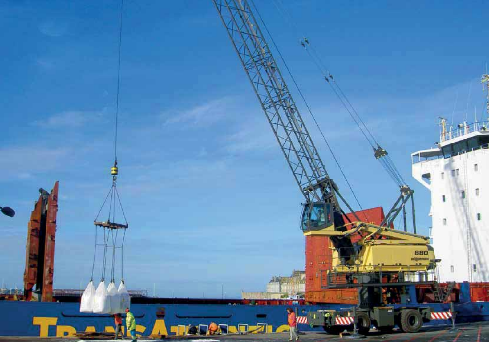
680 HMC (today 2200 HMC) - boom 31,7 m boom length, big bag handling with spreader on loading hook; France 680 HMC (heute 2200 HMC) - Auslegerlänge 31,7 m, Big Bag Umschlag mit Traverse am Lasthaken; Frankreich
