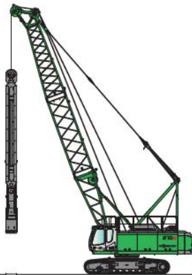
Benne à parois moulées
