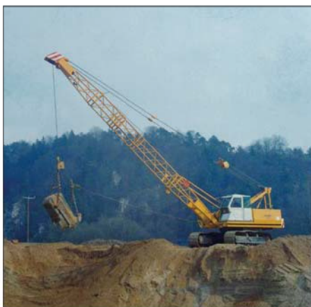
1969 : Première pelle à câbles au monde entièrement hydraulique, SK 15
