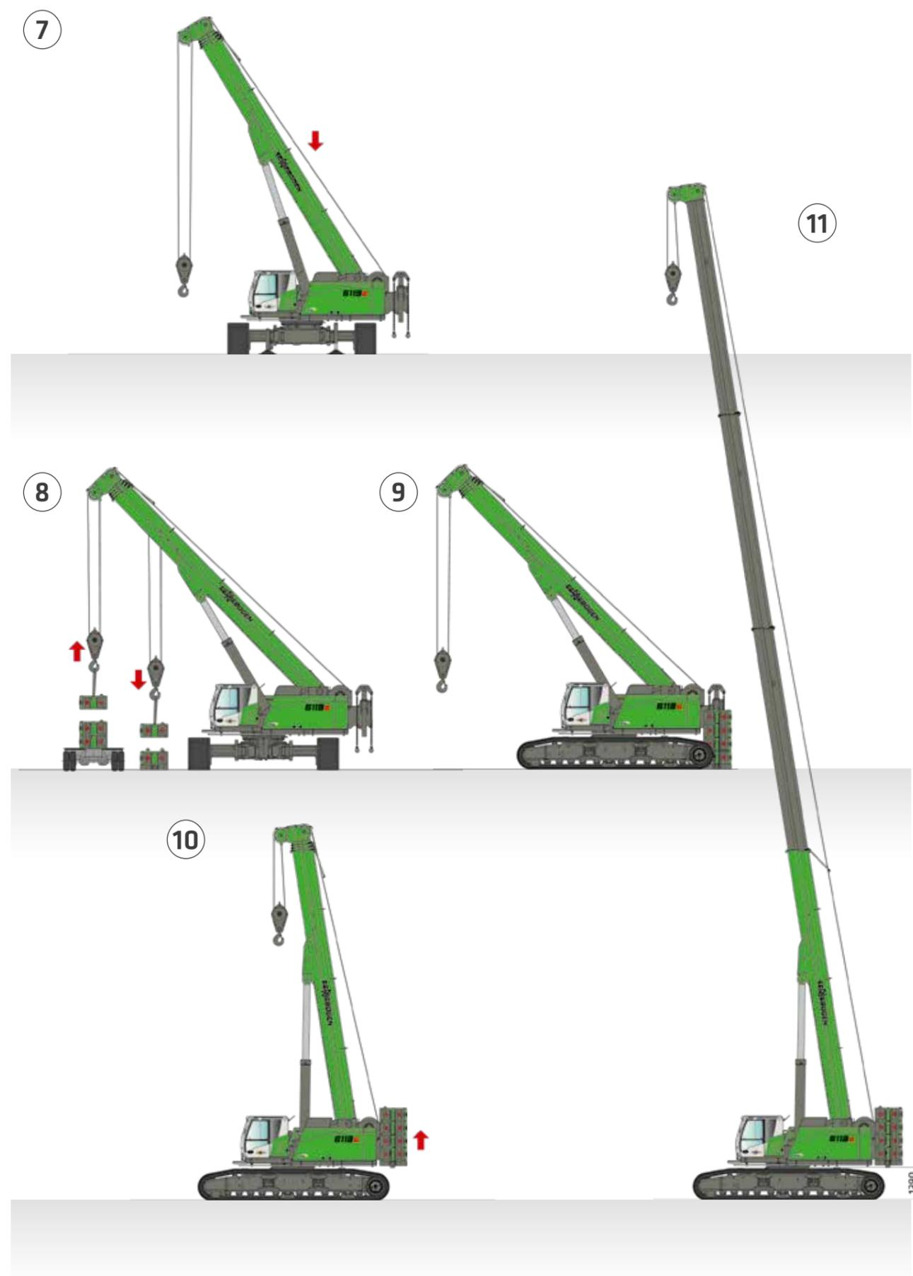
SYSTÈME DE MONTAGE AUTONOME
