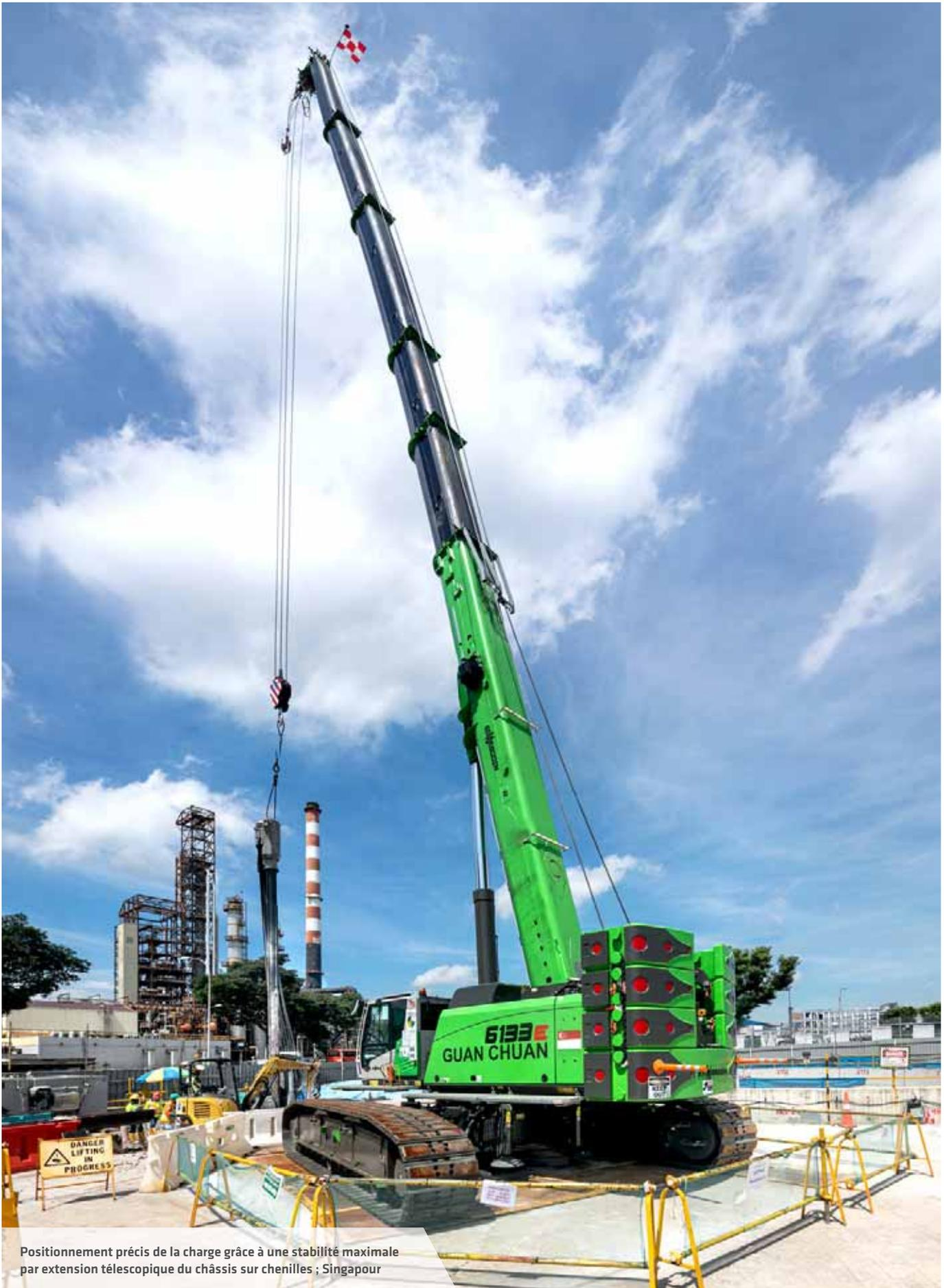
Positionnement précis de la charge grâce à une stabilité maximale par extension télescopique du châssis sur chenilles ; Singapour
