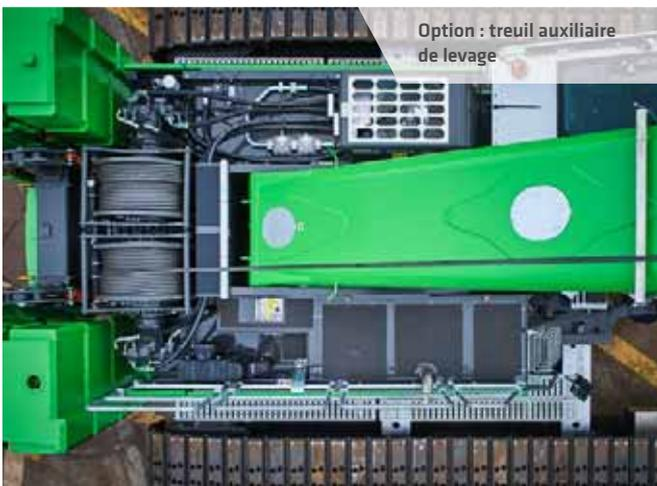
Option : treuil auxiliaire de levage
