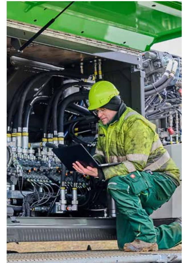
Alle Wartungs- und Servicepunkte sind übersichtlich angeordnet und gut erreichbar. Die eindeutige Kennzeichnung der Bauteile macht die Orientierung einfach.
