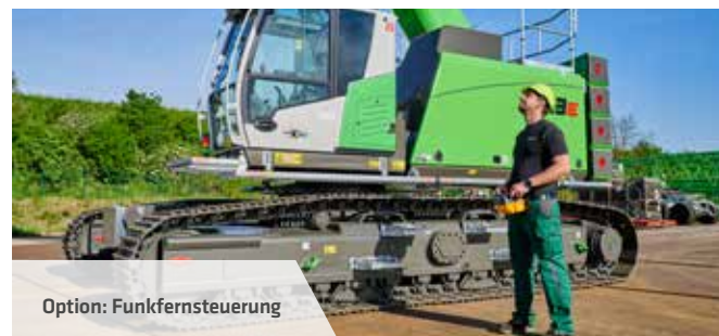
Option: Klappbare Laufstege beidseitig am Oberwagen
