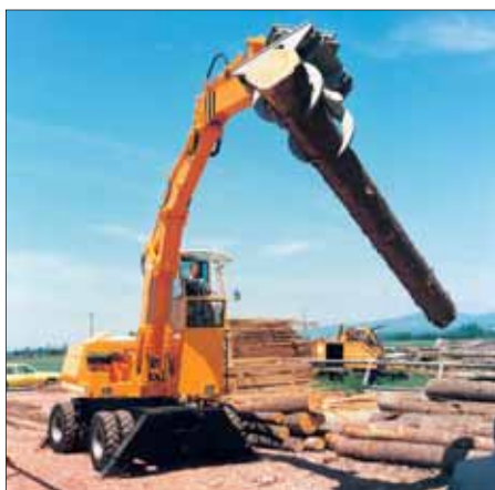
1974 : machine de manutention du bois avec cabine conducteur surélevée
